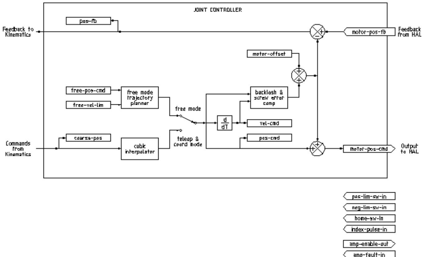
Abbildung 3.1: Blockdiagramm des Joint Controllers
