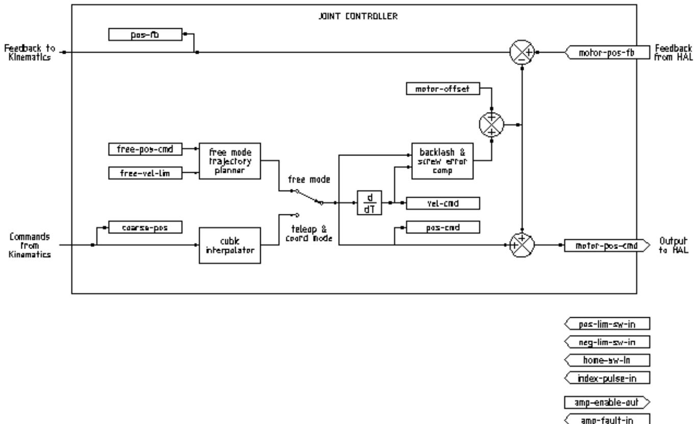
Abbildung 3.1: Blockdiagramm des Joint Controllers
