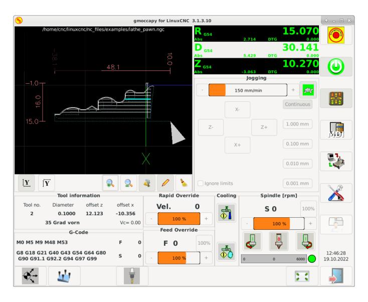
Figure 10.19: Normal Lathe
