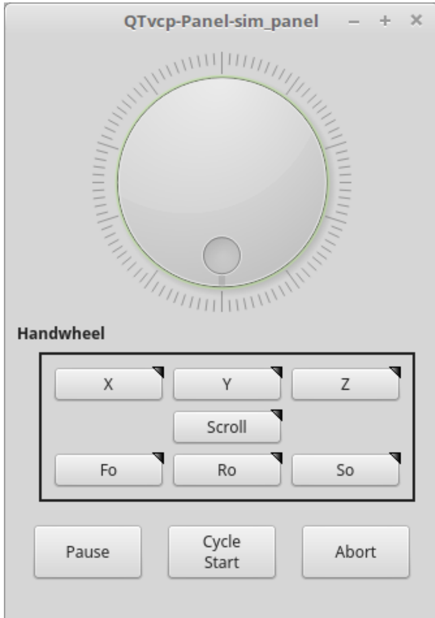
Figure 12.75: QtVCP sim_panel - Імітована панель керування для тестування екрану.
