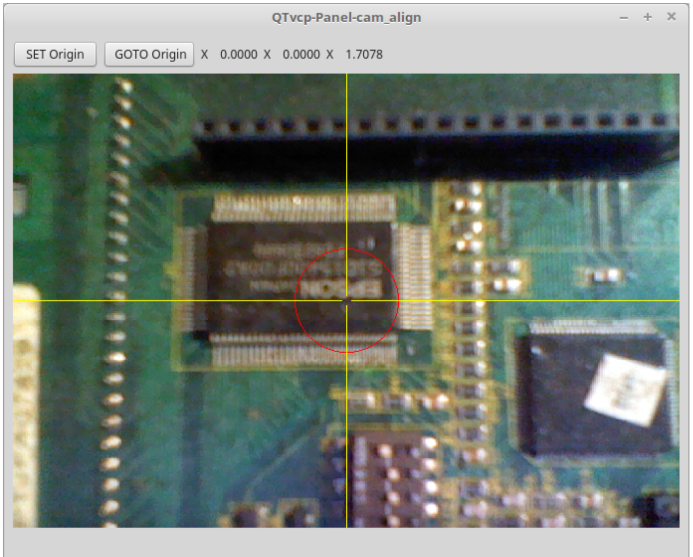
Figure 12.63: cam_align - Вирівнювання камери VCP
