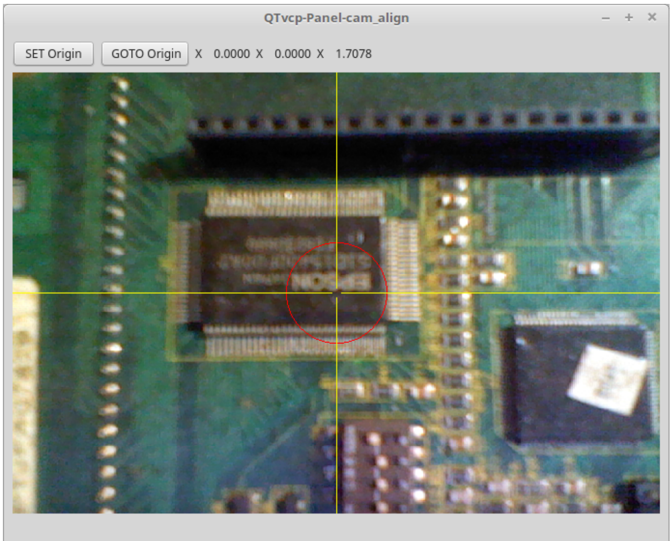
Figure 12.74: Панель QtVCP cam_align - панель вирівнювання на основі камери
