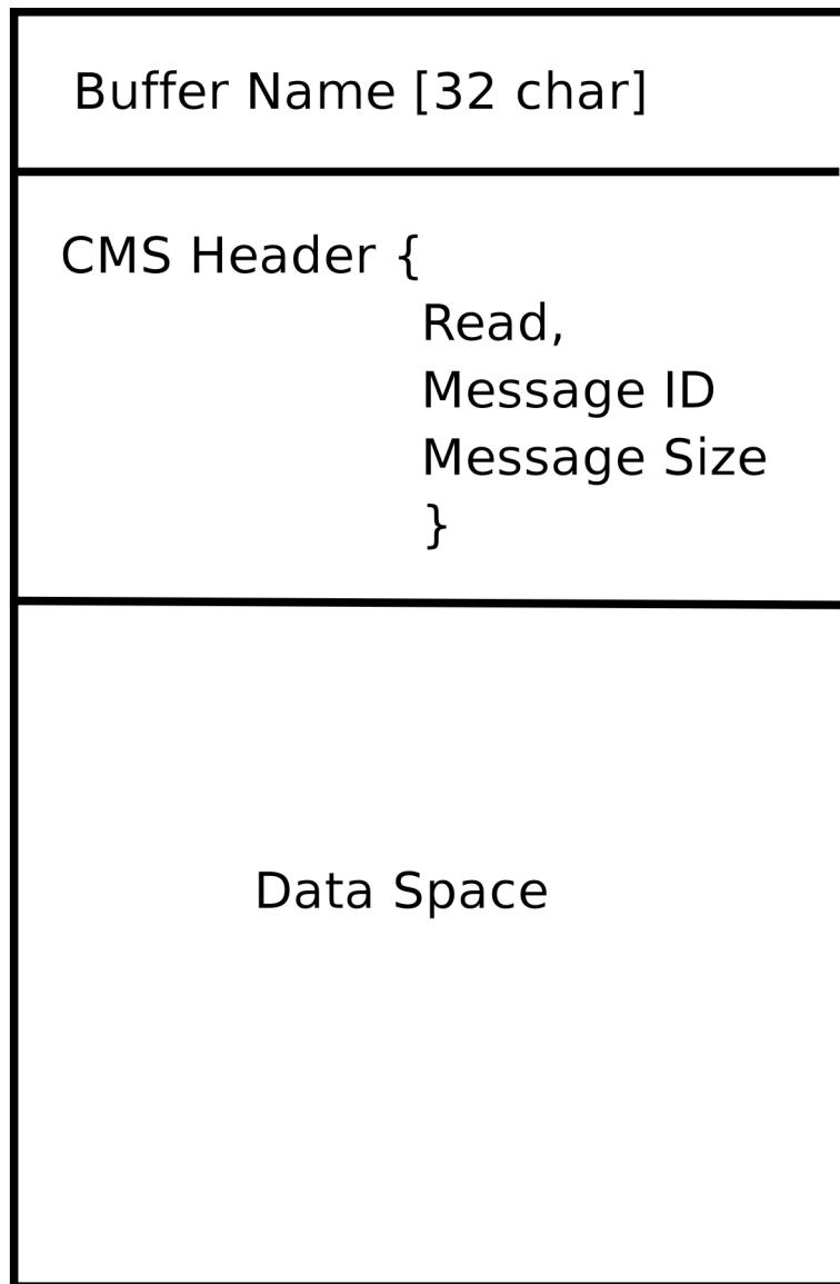
**CMS-Puffer** Die CMS-Basisklasse ist in erster Linie für die Erstellung der Kommunikationswege und der Schnittstellen zum Betriebssystem verantwortlich.
