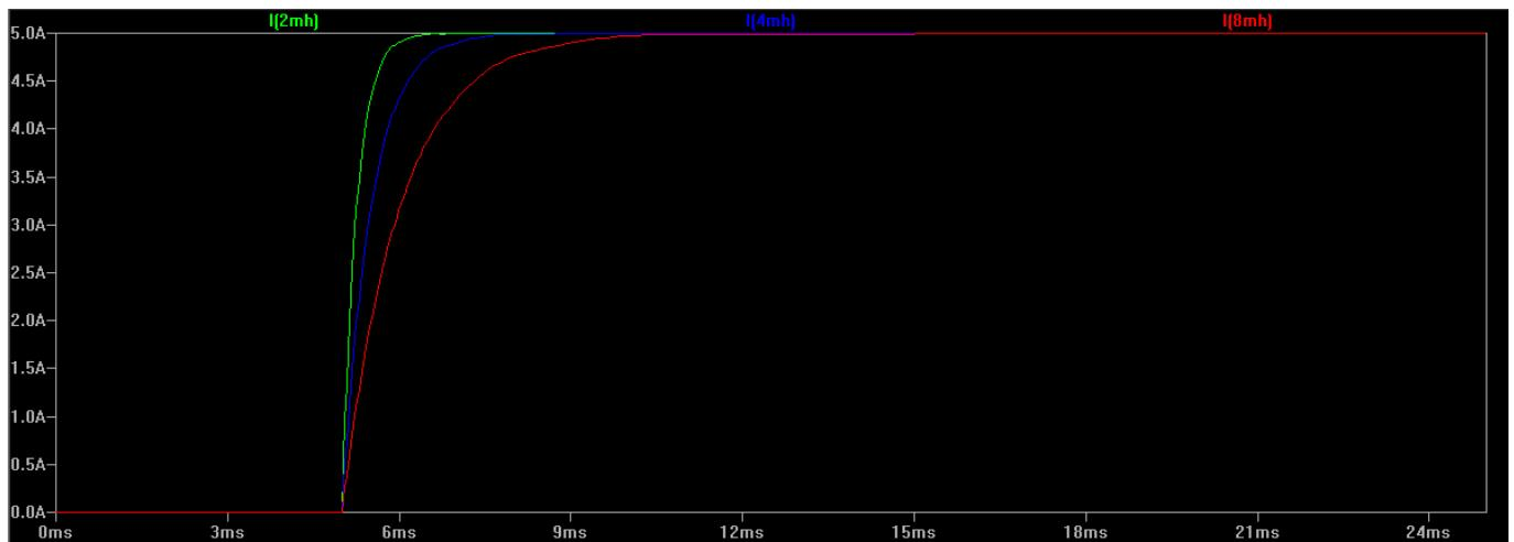
Wenn die Geschwindigkeit, mit der die Sprünge an die Spulen angelegt werden, deutlich kürzer ist als die Anstiegszeit, ist es leicht zu erkennen, dass die Wicklung weniger Zeit hat, die volle magnetische Anziehungs Kraft auf den Rotor zu erreichen, und somit wird das maximale Drehmoment eingeschränkt. Im folgenden Beispiel kann die 2 mH-Spule die volle 5 A-Grenze erreichen, bevor die Schrittspannung entfernt wird, die 4 mH- und 8 mH-Spulen jedoch nicht:
