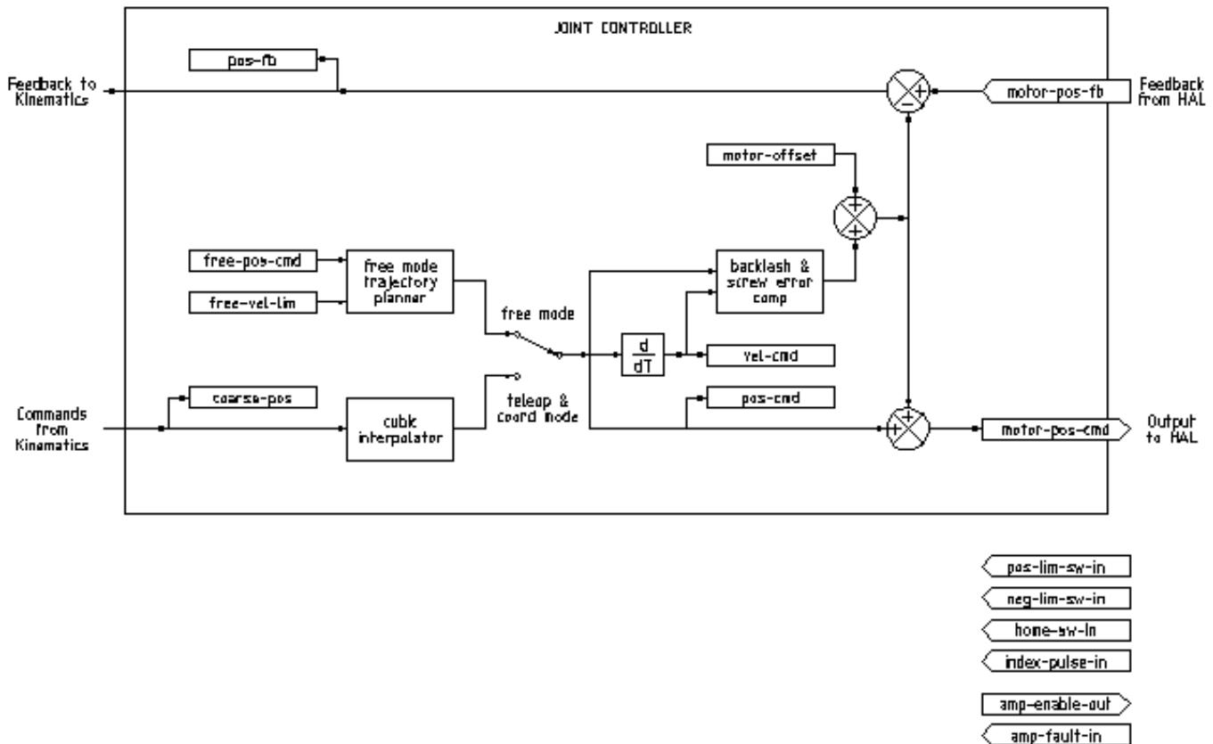
Abbildung 3.1: Blockdiagramm des Joint Controllers
