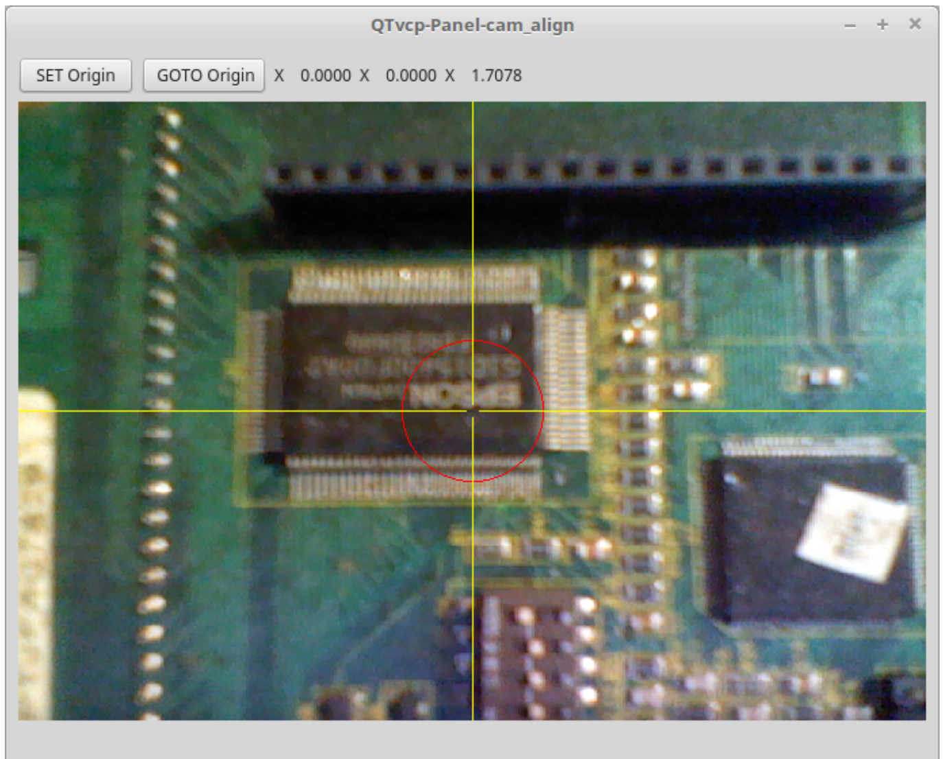
Abbildung 12.60: cam_align - Kameraausrichtung VCP
