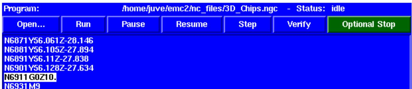
**Bedientasten** Die Buttons im unteren Teil von TkLinuxCNC werden verwendet, um die Ausführung eines Programms zu steuern:
