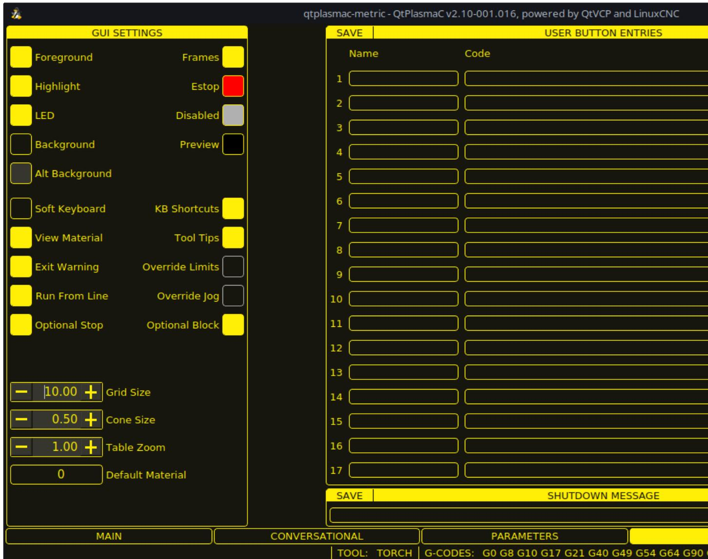
Diese Registerkarte wird verwendet, um GUI-Konfigurationsparameter, Schaltflächentext und Herunterfahrtext anzuzeigen, die selten geändert werden, sowie einige Dienstprogrammschaltflächen.
