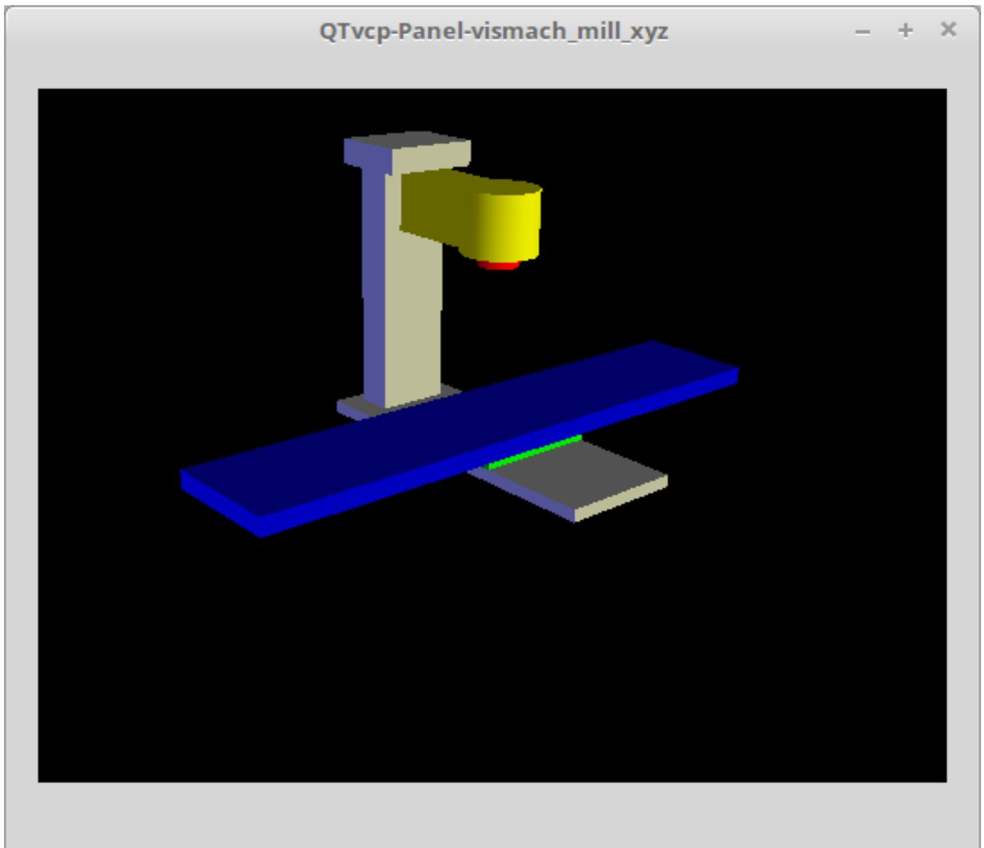
Abbildung 12.65: QtVismach - 3-Achsen-Fräse Eingebautes Panel
