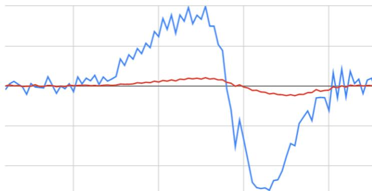
So sollte es möglich sein, den gleitenden Durchschnitt mit dem  $dv/dt$  zu vergleichen und THC-Betrieb zu stoppen, sobald die  $dv/dt$  den normalen Bereich aufgrund von Verzug erwartet überschreitet. Es muss noch mehr Arbeit in diesem Bereich investiert werden, damit es zu einer funktionierenden Lösung in LinuxCNC kommt.
