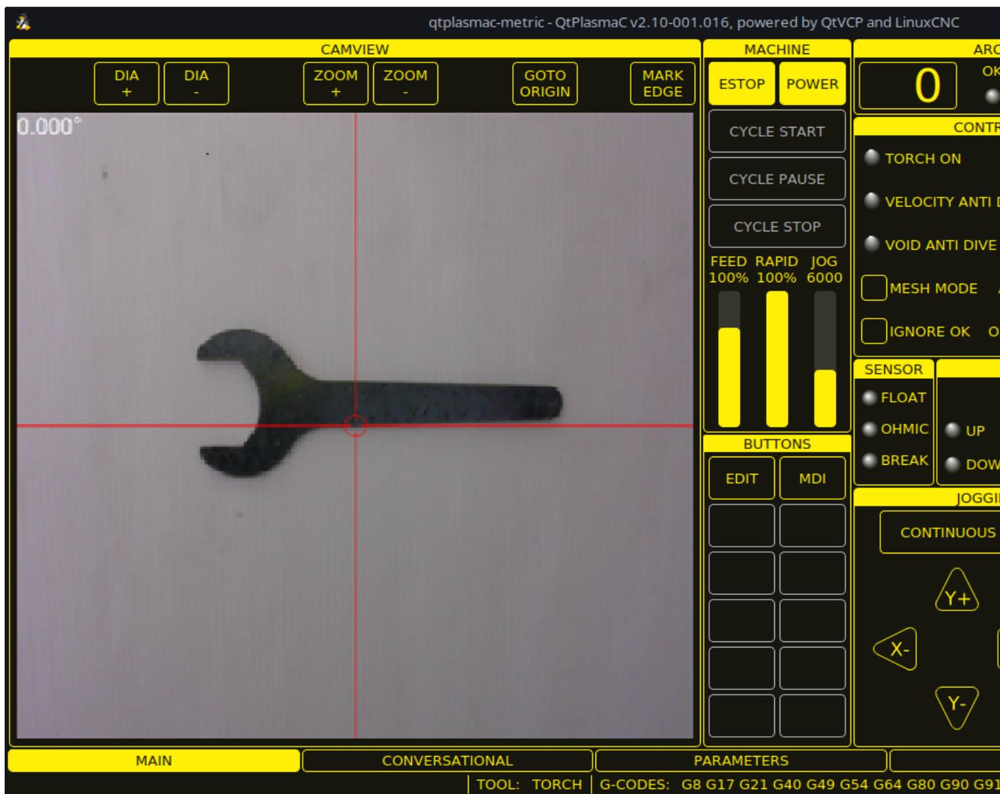
QtPlasmaC hat die Möglichkeit, eine USB-Kamera zu verwenden, um den Ursprung mit oder ohne Rotationskompensation festzulegen. Mit einer Rotationskompensation kann der Arbeitsversatz auf ein Materialblatt mit nicht parallel zu den X/Y-Achsen der Maschine verlaufenden Kanten ausgerichtet werden. Die Schaltfläche CAMERA wird aktiviert, nachdem das Gerät referenziert wurde.
