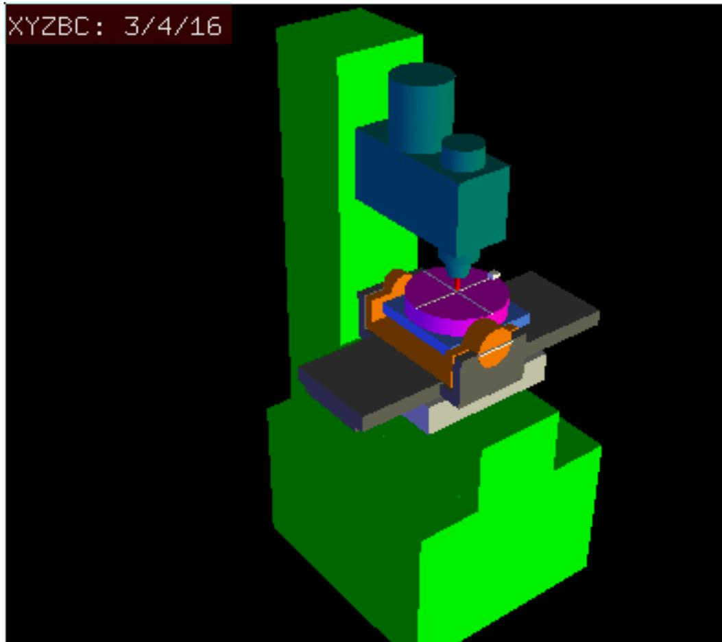
Abbildung 9.8: Vismach-Modell von xyzbc-trt mit Rotationsachsenversatz (negativ)
