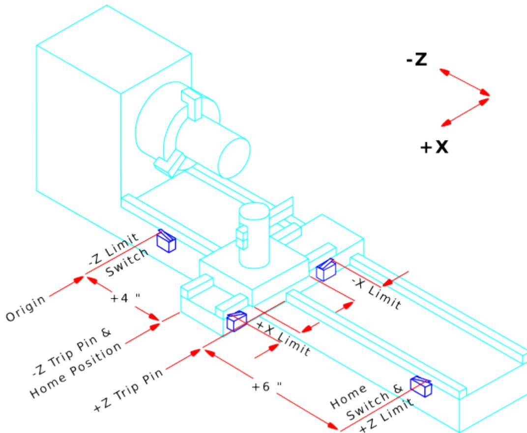
Abbildung 2.15: Typische Drehmaschinen-Konfiguration
