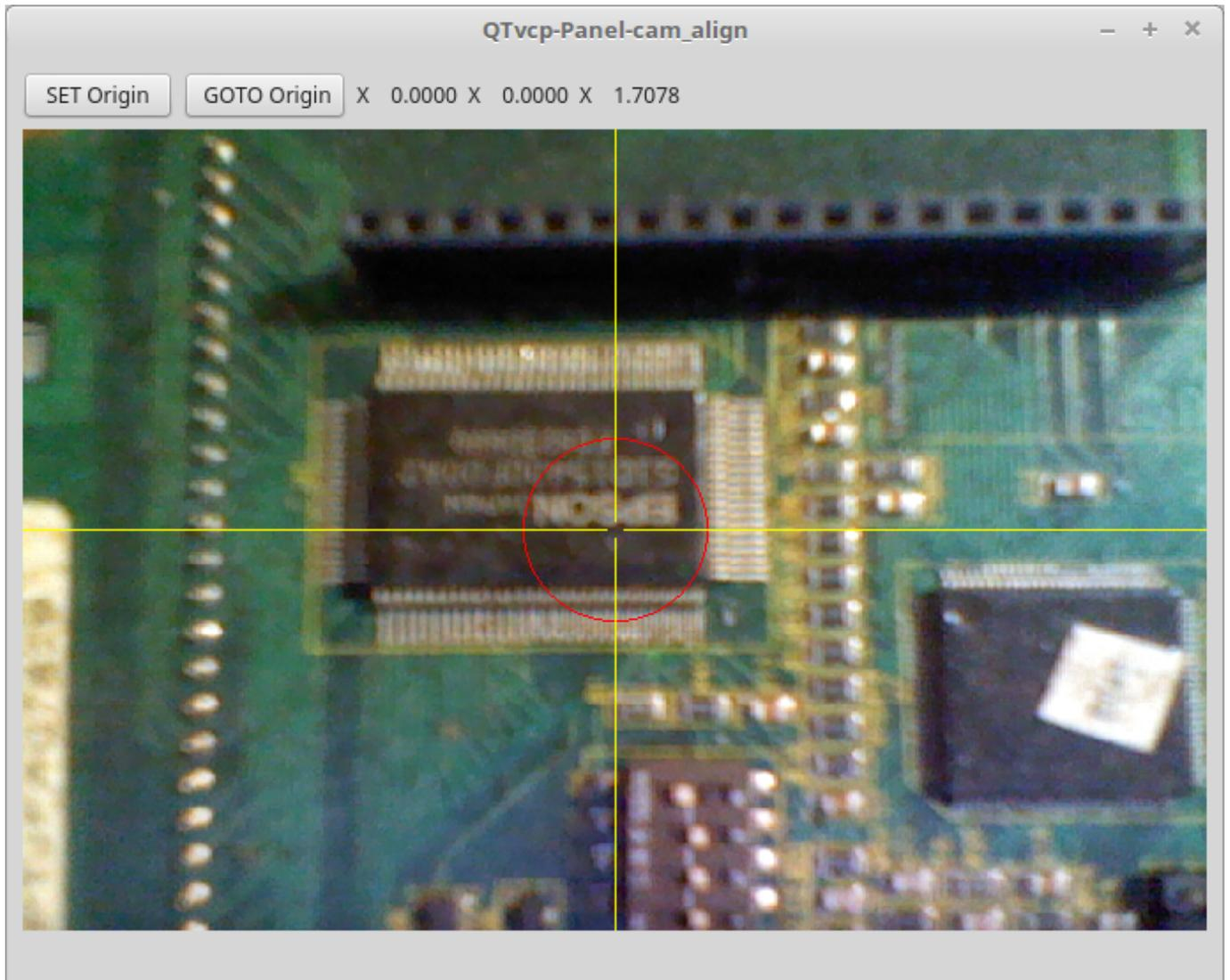
Abbildung 12.63: cam\_align - Kameraausrichtung VCP
