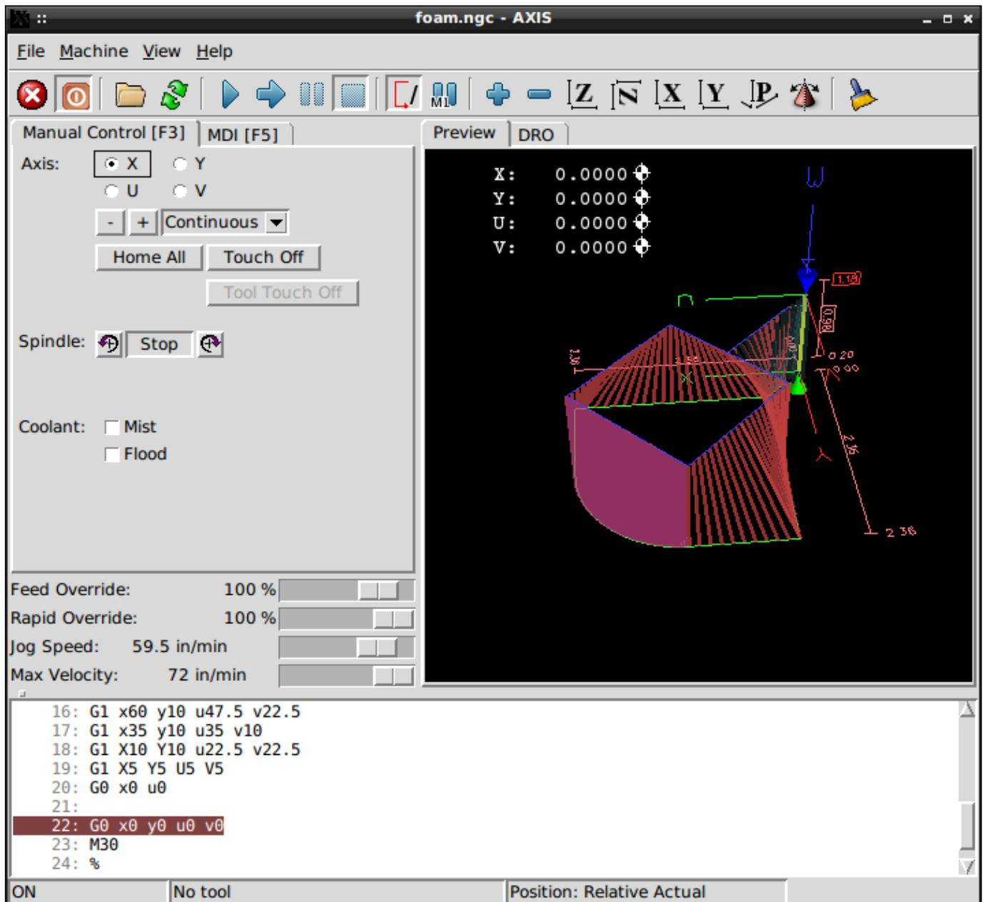
Abbildung 10.12: Modus Schaumstoffschneiden
