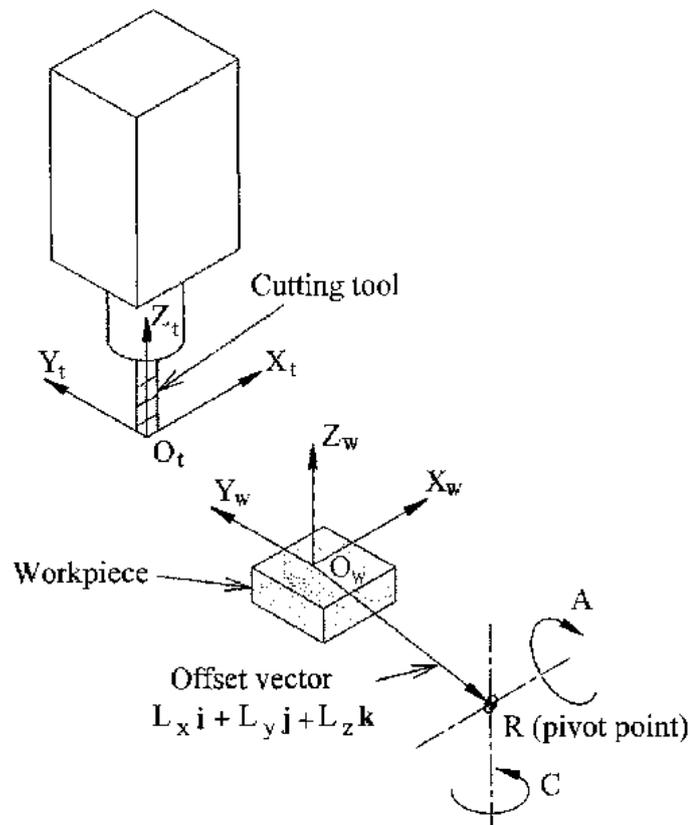
Abbildung 9.5: Kipp-/Drehkonfiguration des Tisches
