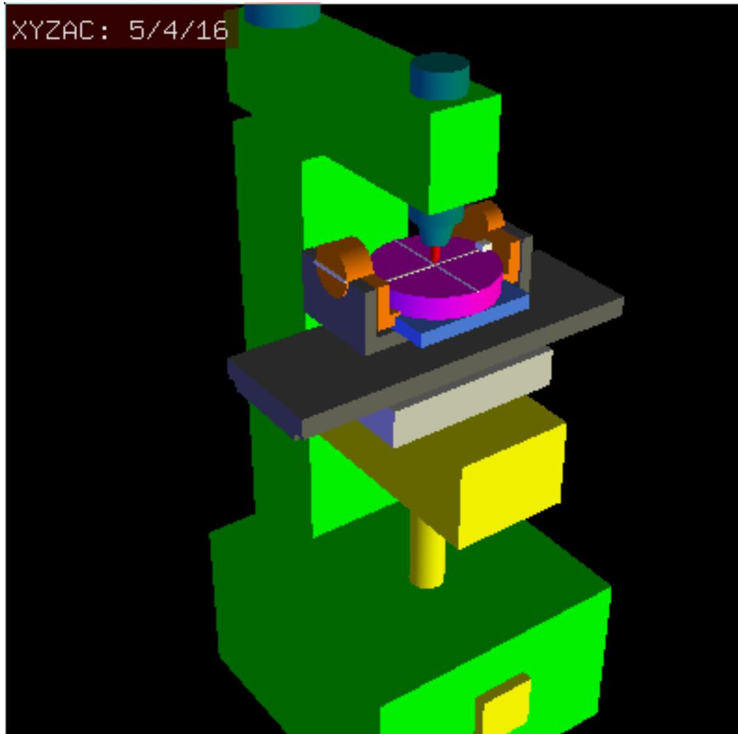
Abbildung 9.6: Vismach-Modell von xyzac-trt mit Rotationsachsenversatz (positiv)
