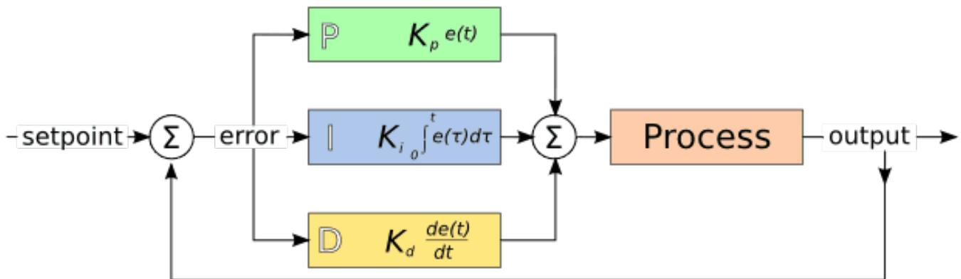
Abbildung 4.2: PID-Schleife
