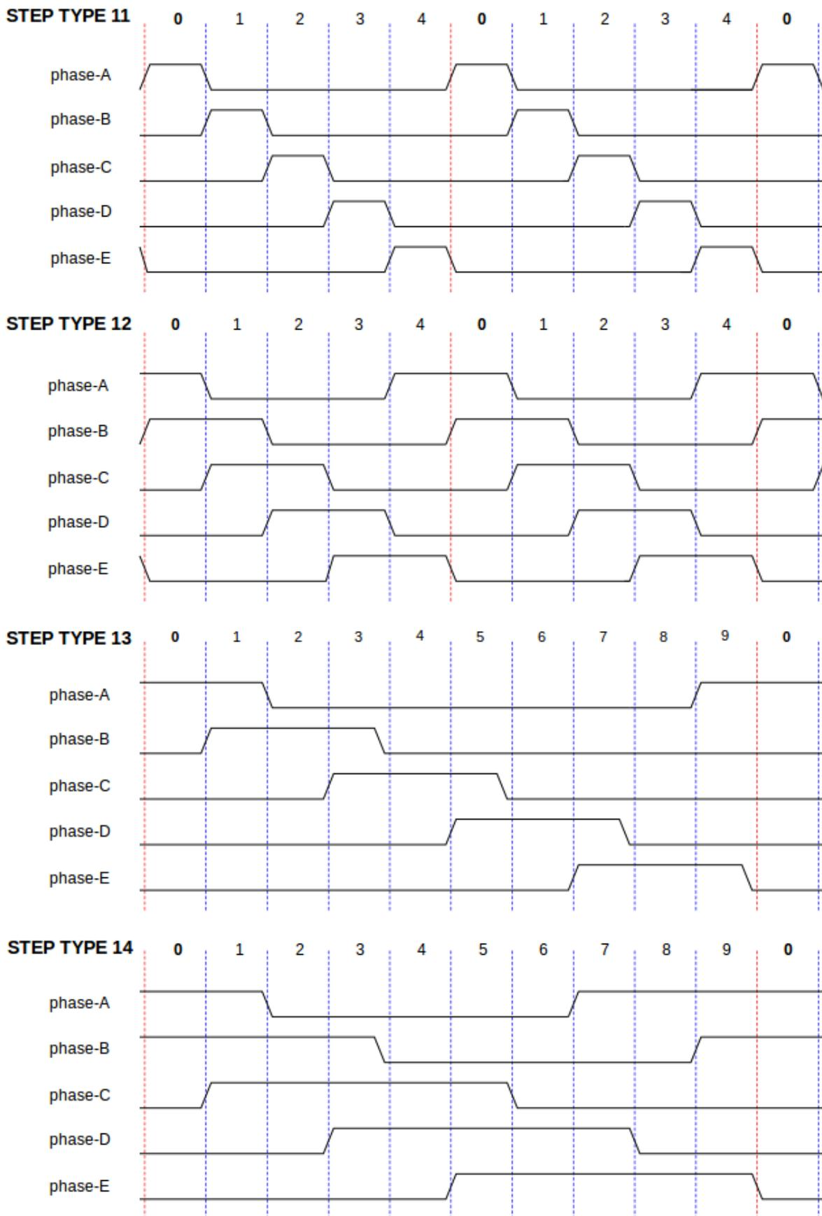
Abbildung 5.23: Fünf-Phasen-Schritttypen
