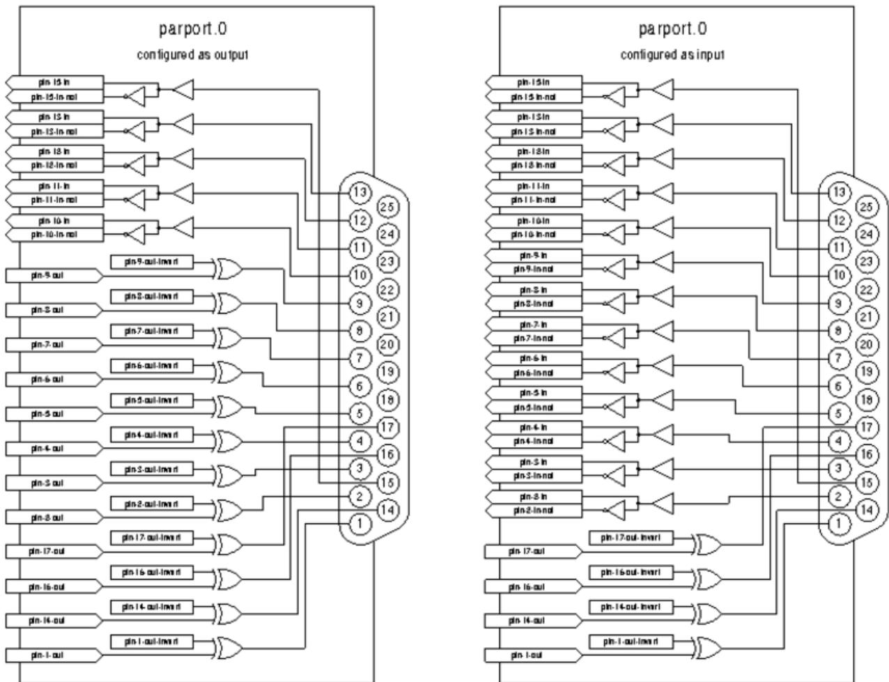
Abbildung 6.1: Parport-Blockdiagramm
