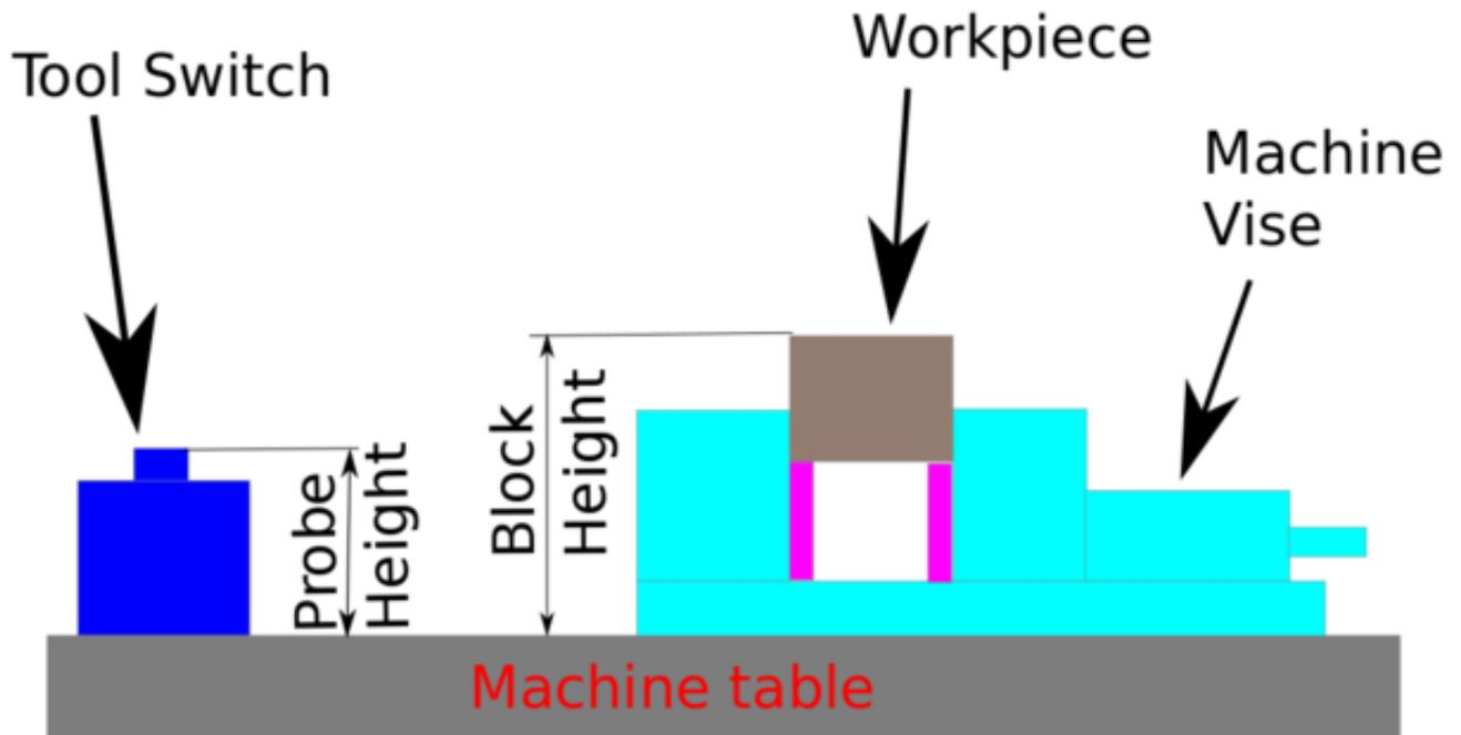
Abbildung 10.32: Automatische Werkzeugvermessung
