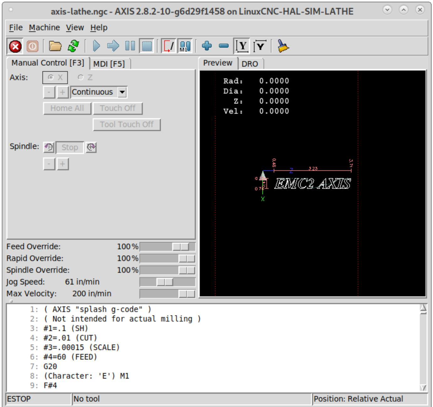
Abbildung 10.9: AXIS-Drehmaschinenmodus
