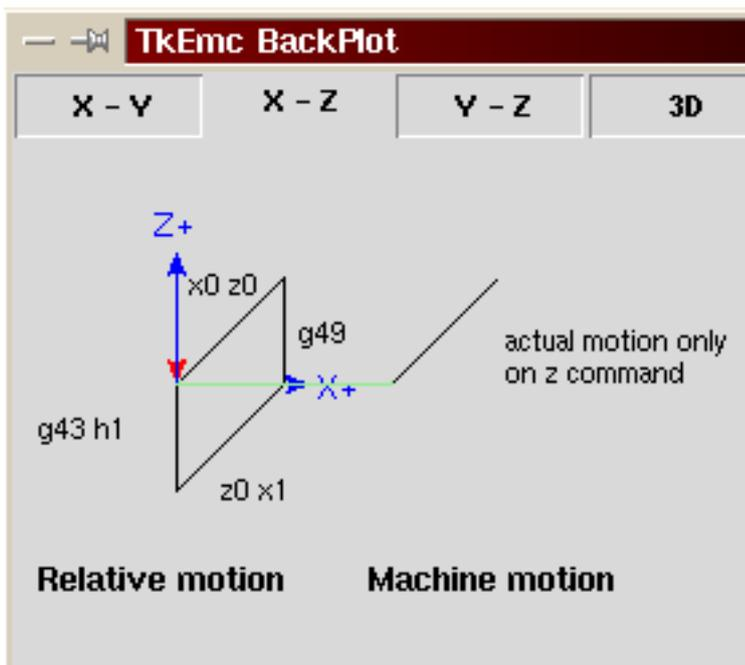
Mit diesem Programm wird die Maschine in den meisten Fällen den Offset in Form einer Rampe während der Bewegung in xyz nach dem Wort G43 anwenden.
