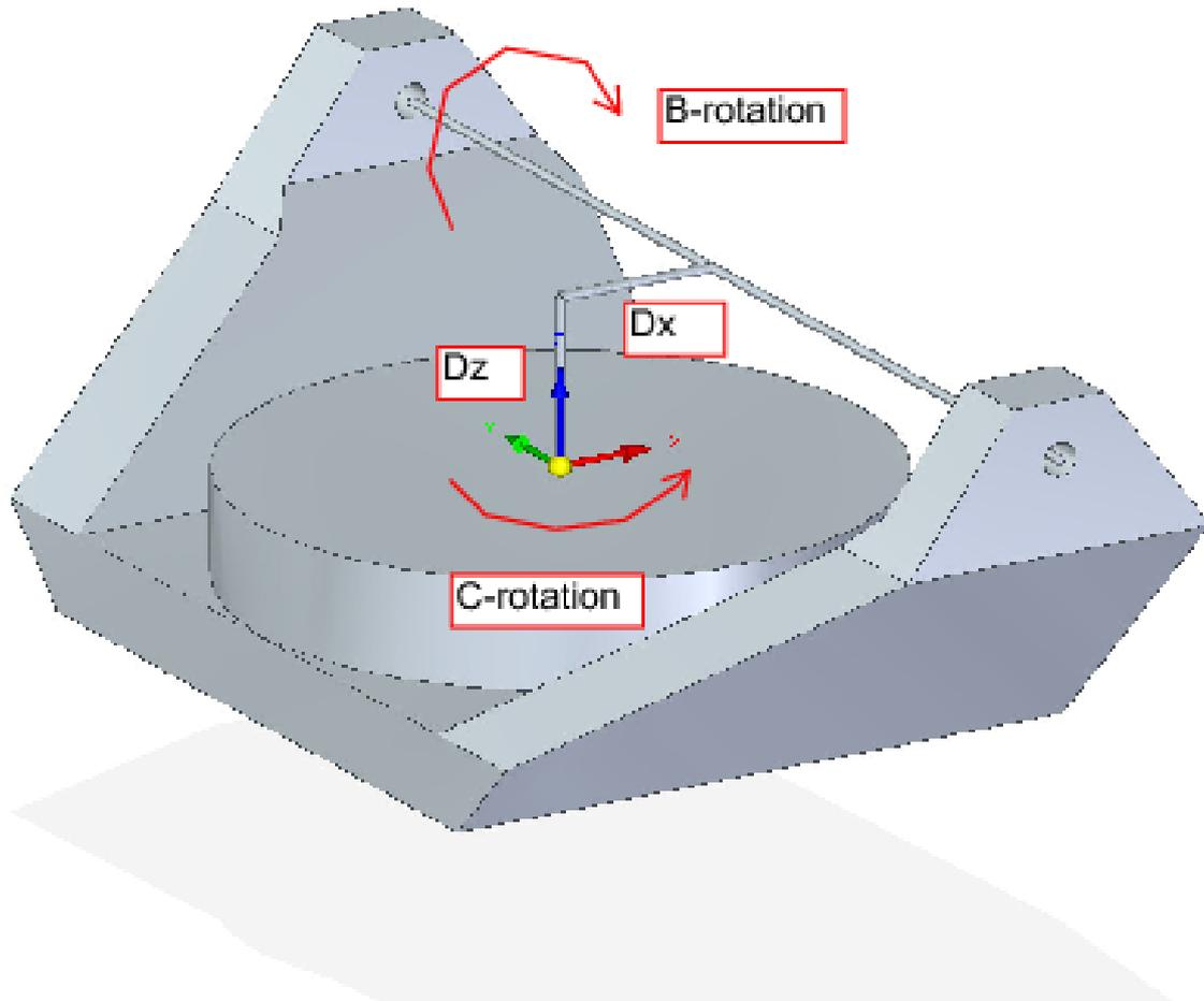
Abbildung 9.9: Kipp-/Drehkonfiguration des Tisches xyzbc-trt, mit Achsenversatz
