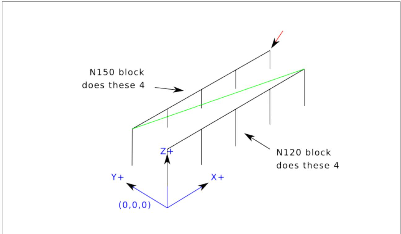
**Zwölf Löcher im Viereck** Dieses Beispiel demonstriert die Verwendung des L Werts, um eine Reihe von inkrementellen Bohrzyklen für aufeinanderfolgende Codeblöcke innerhalb desselben G81 Bewegungsmodus zu wiederholen. In diesem Beispiel werden 12 Bohrungen mit fünf Codezeilen im Modus "Festgelegte Bewegung" erzeugt.
