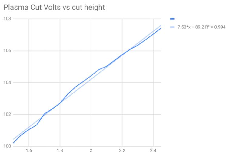
Dieses Diagramm wurde aus einer Stichprobe von etwa 16.000 Messwerten bei unterschiedlichen Schnitthöhen erstellt, und die Regressionsanalyse zeigt 7,53 V/mm mit einer Zuverlässigkeit von 99,4
