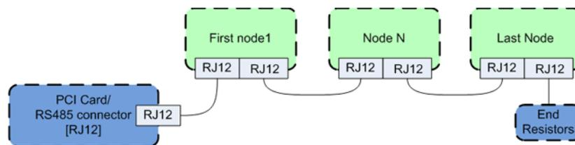
Abbildung 6.8: Anschließen der RS485-Knoten an die GM6-PCI-Karte
