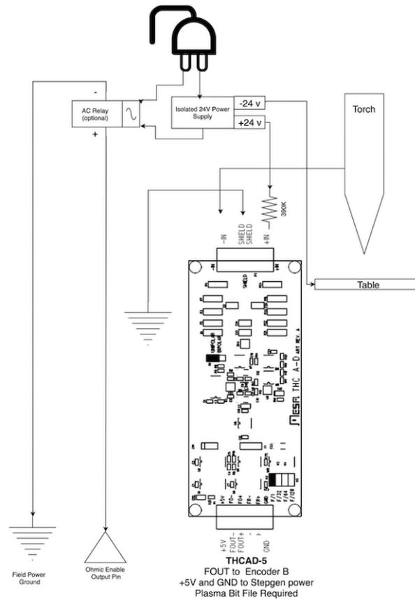
Wir haben eine 15 W Mean Well HDR-15 Ultra Slim DIN Rail Supply 24 V DIN-Schienen-basierte isolierte Stromversorgung verwendet. Dies ist ein doppelt isoliertes Gerät der Isolationsklasse II, das jeder Lichtbogenstand hält, die an die Klemmen angelegt werden könnte.
