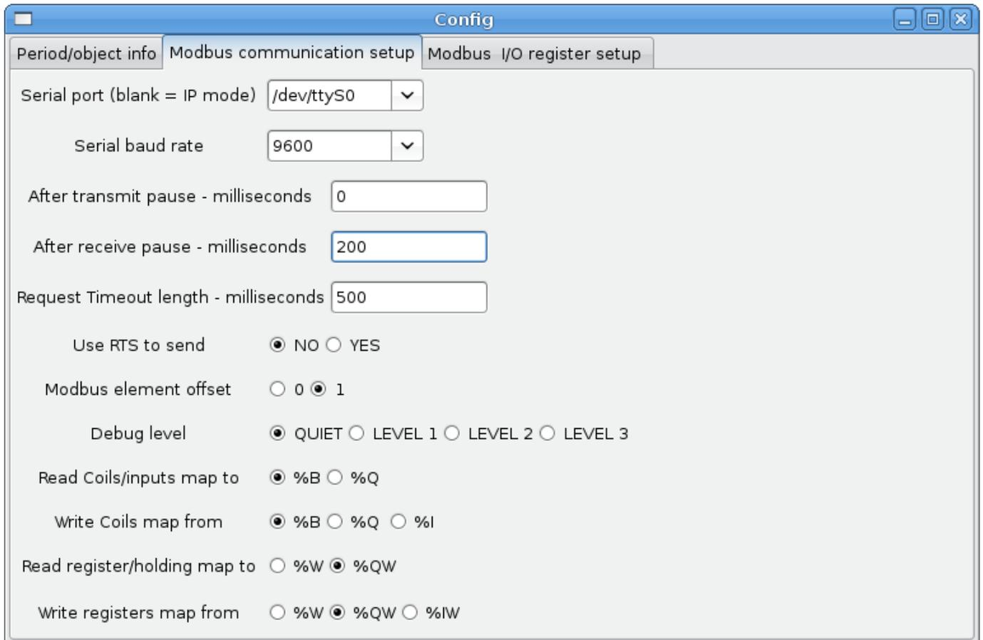
Abbildung 8.13: Modbus-Kommunikationskonfiguration
