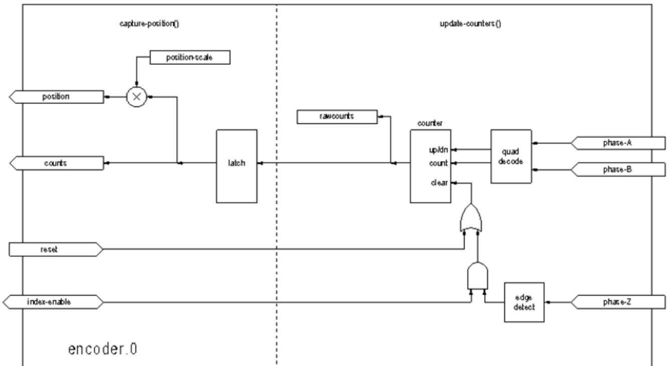
Abbildung 5.24: Encoderzähler-Blockdiagramm
