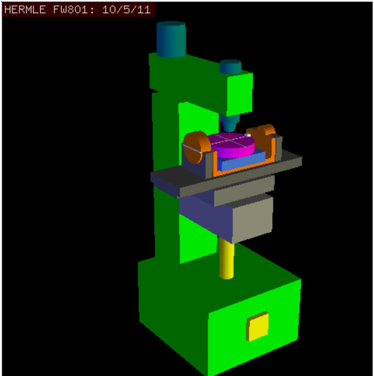
Abbildung 9.4: vismach-Modell von xyzac-trt mit übereinstimmenden Drehachsen
