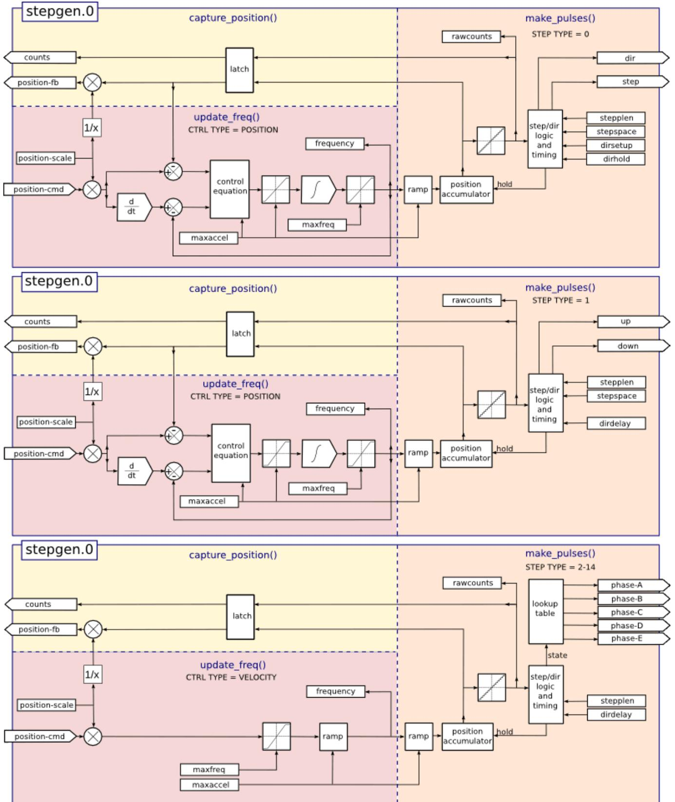
Abbildung 5.19: Schrittpulsgenerator-Blockdiagramm Positionsmodus
