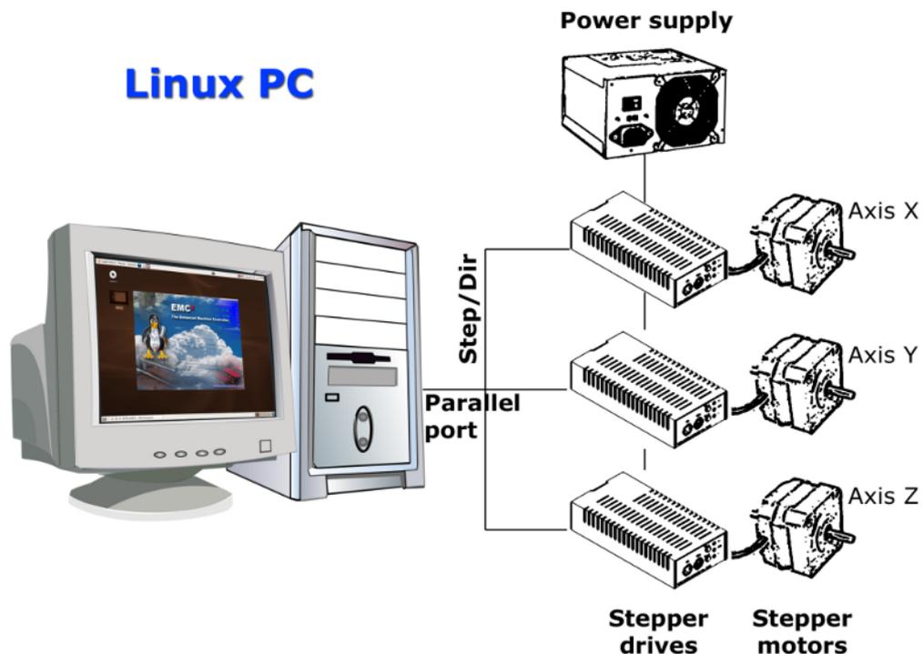
Abbildung 2.1: Einfache LinuxCNC-gesteuerte Maschine
