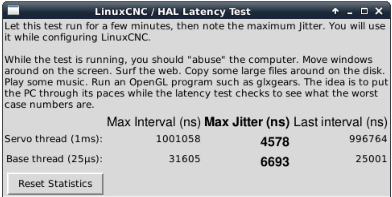
Abbildung 3.3: Latenz-Test
