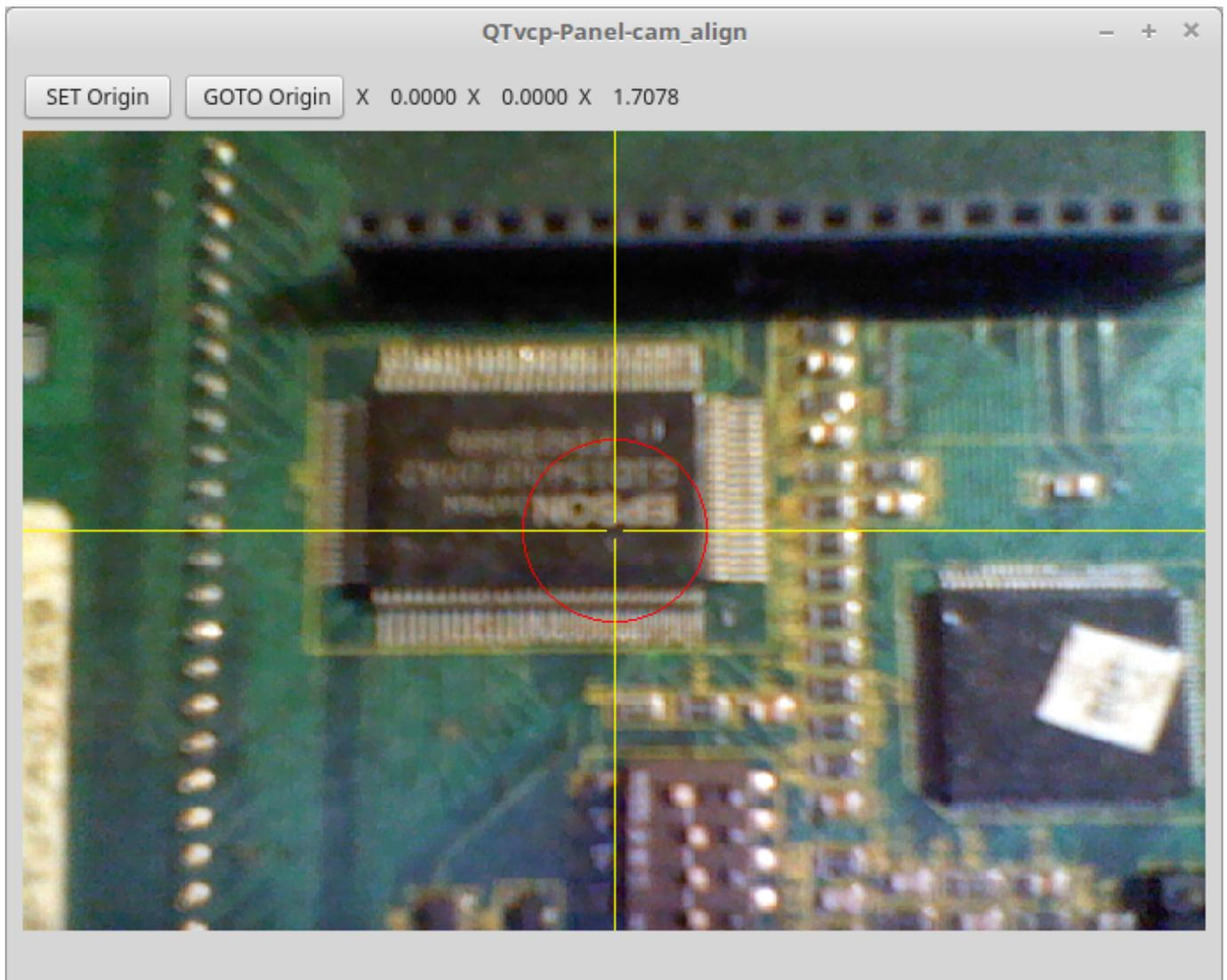
Abbildung 12.74: QtVCP cam\_align Panel zur Kamera-basierten Ausrichtung
