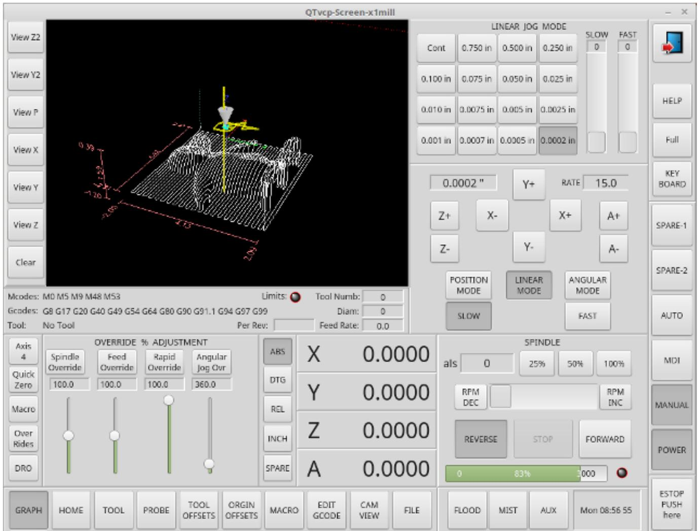
Abbildung 12.59: X1mill - 4-Achsen-Beispiel
