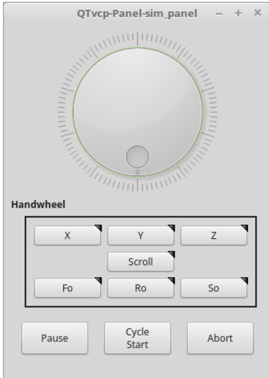
Abbildung 12.75: QtVCP sim\_panel - Simuliertes Bedienfeld für Bildschirmtests.
