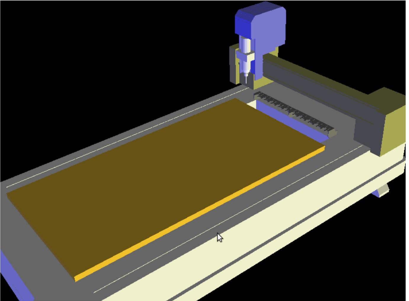
Abbildung 12.78: QtVCP vismach\_router\_atc - 3-Achsen Portalfräsen 3D-Ansichtspanel
