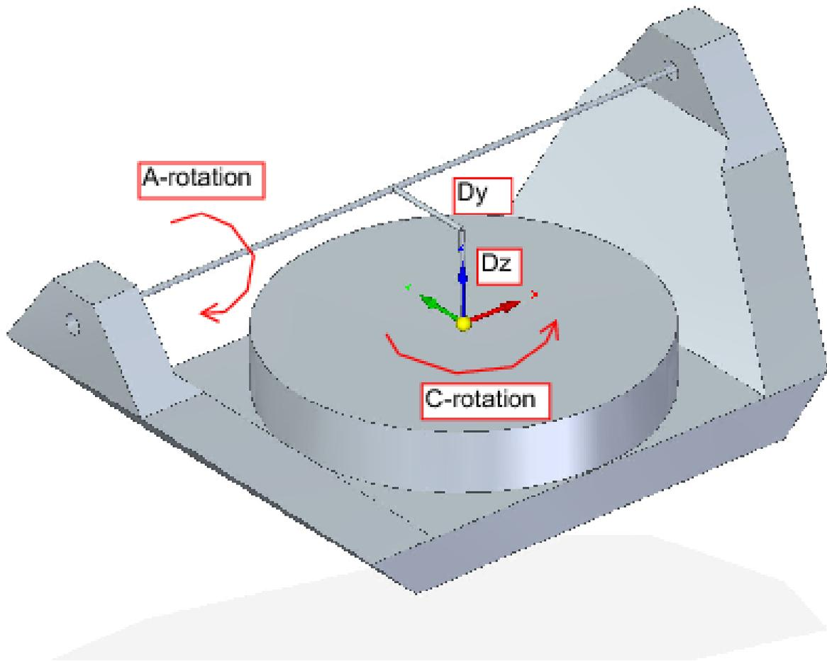
Abbildung 9.7: Kipp-/Drehkonfiguration des Tisches xyzac-trt, mit Achsenversatz
