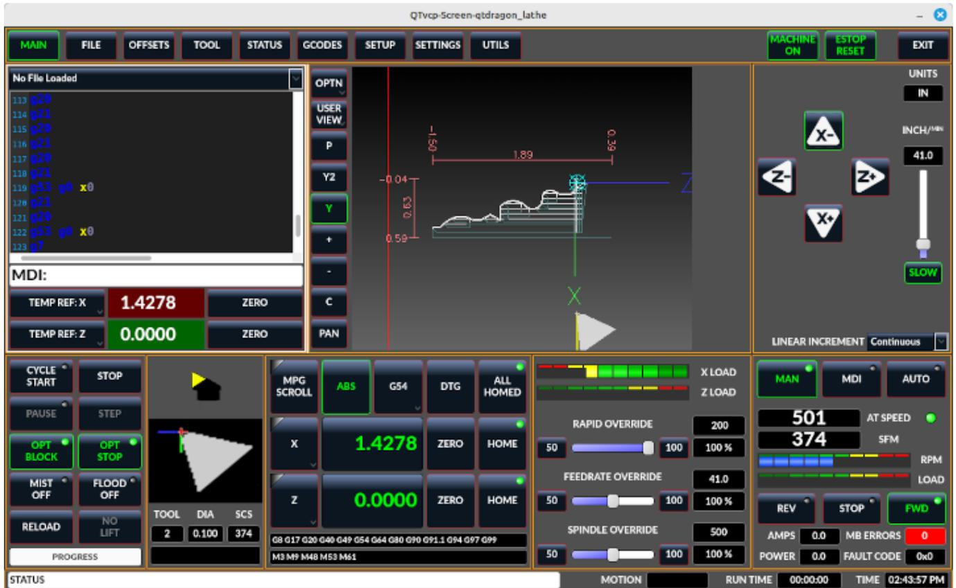
QtDragon\_lathe ist eine modifizierte Version von QtDragen um den Anforderungen von Drehmaschinen besser zu genügen.
