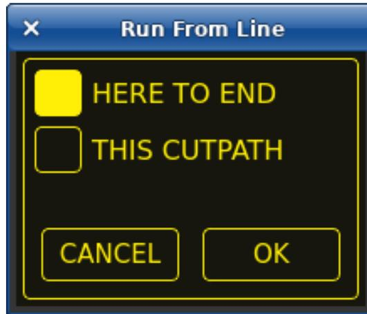
**HERE TO END** wird vom Beginn der ausgewählten Zeile bis zum Ende der G-Code-Datei ausgeführt, mit der Option, einen Lead-in hinzuzufügen.
