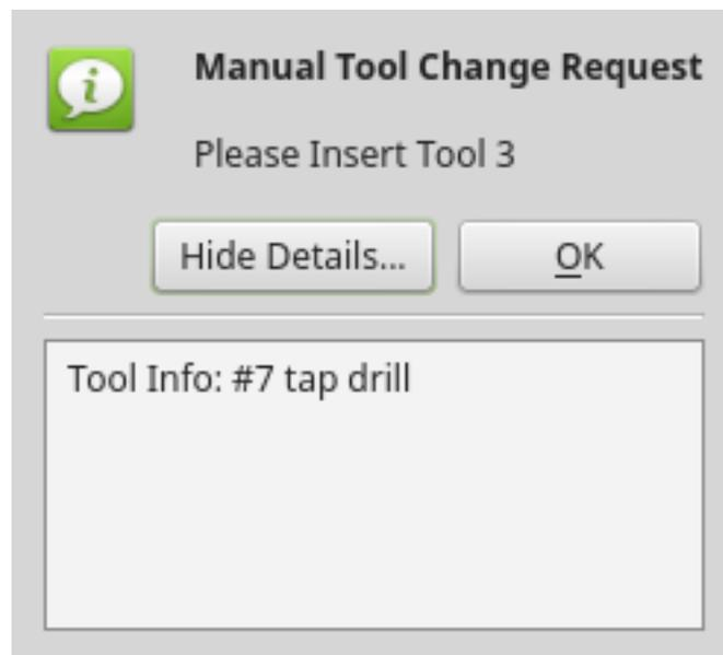
Abbildung 12.97: QtVCP ToolDialog: Dialog zum manuellen Werkzeugwechsel
