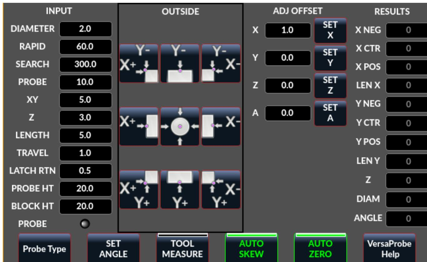
Abbildung 12.106: QtVCP VersaProbeDialog: Dialog-Widget für Werkstück Touch Probing
