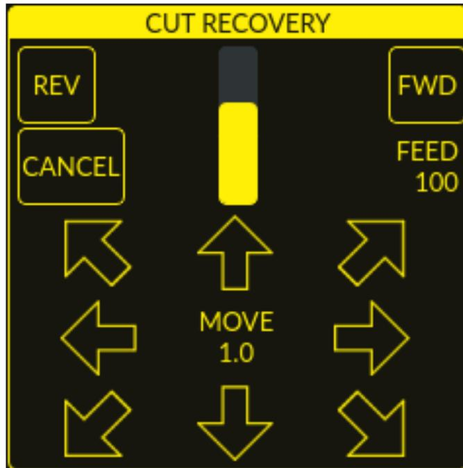
Diese Funktion erzeugt eine Tafel CUT RECOVERY, die es ermöglicht, den Brenner während einer [unterbrochenen Bewegung](#) (engl. paused motion)-Ereignisses von der Schneidbahn wegzubewegen, um den Brenner über einem Reststück des zu schneidenden Materials zu positionieren, so dass der Schnitt mit einem minimierten Lichtbogen-Divot neu beginnt. Das Feld CUT RECOVERY wird automatisch über dem Feld JOGGING angezeigt, wenn die Bewegung angehalten wird.
