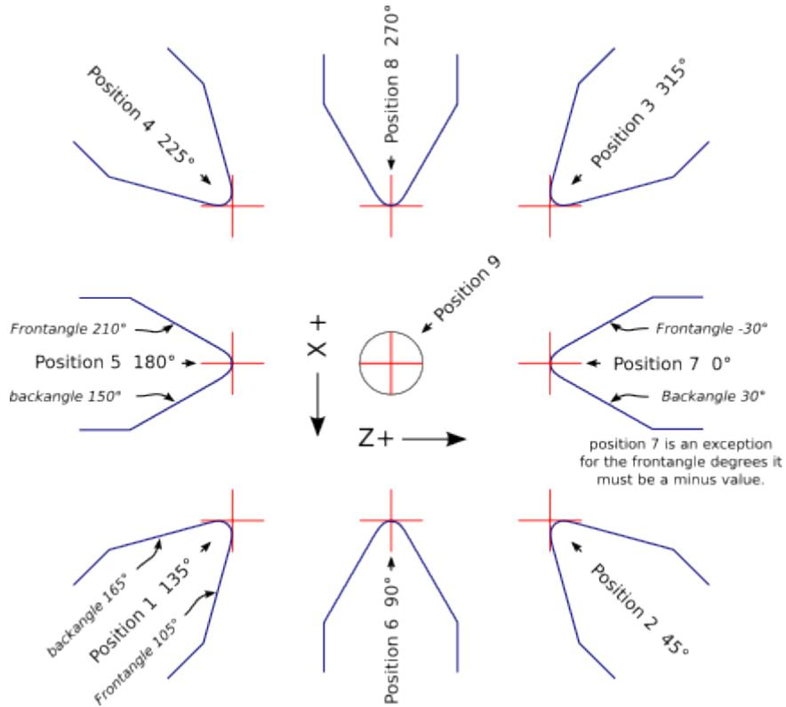
Abbildung 2.16: Ausrichtung des Drehwerkzeugs
