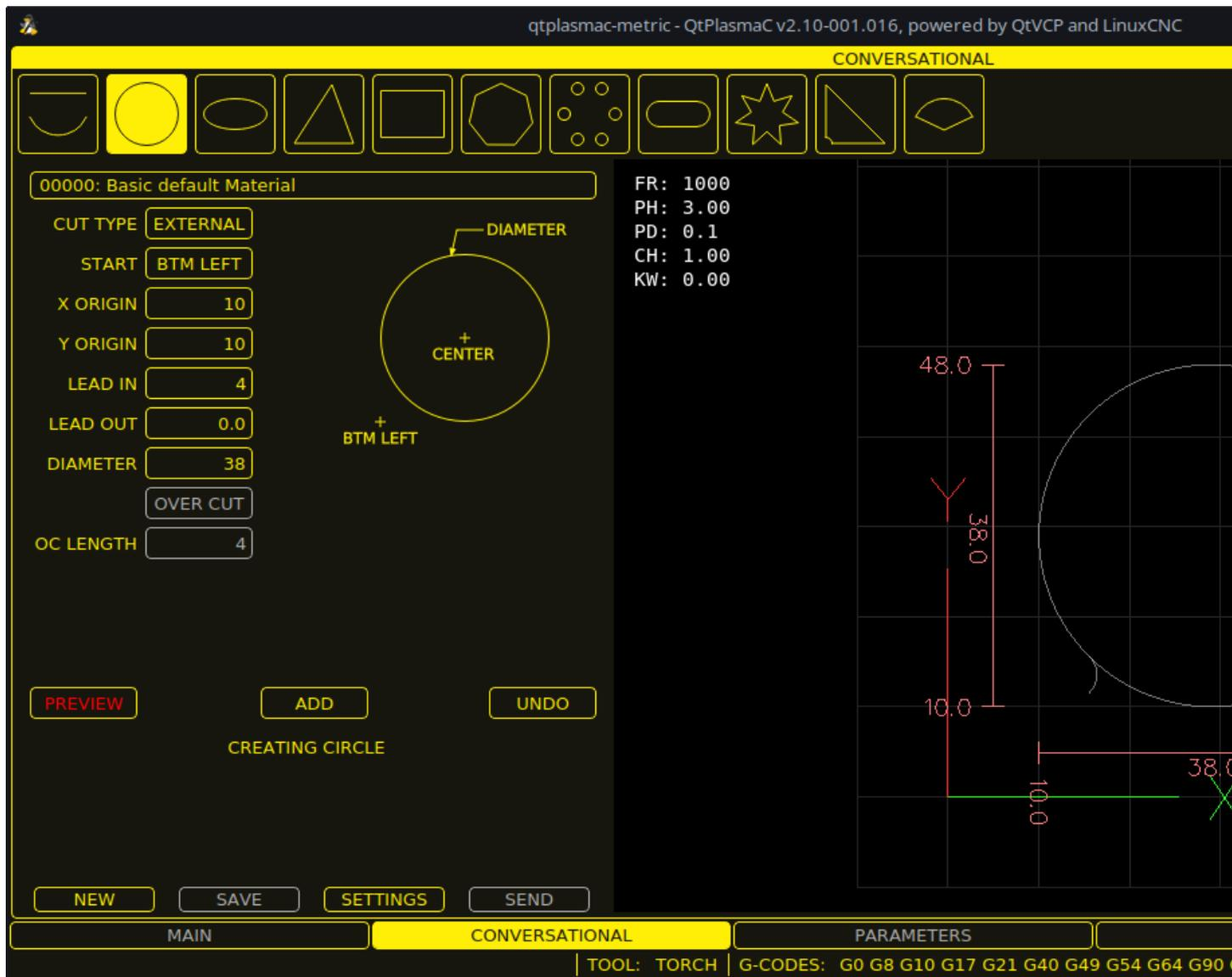
Die **Conversational Shape** (engl. für Gestalt/Form) **Bibliothek** besteht aus mehreren grundlegenden Formen und Funktionen, die den Benutzer bei der schnellen Erstellung von G-Code an der Maschine unterstützen, um einfache Formen schnell zu schneiden. Diese Funktion befindet sich auf der **CONVERSATIONAL** Registerkarte.
