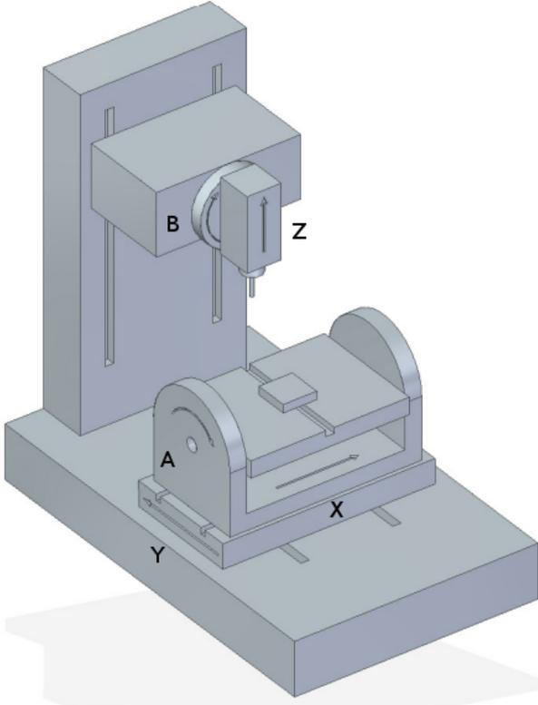
Abbildung 9.11: Spindel-/Tischkippkonfiguration
