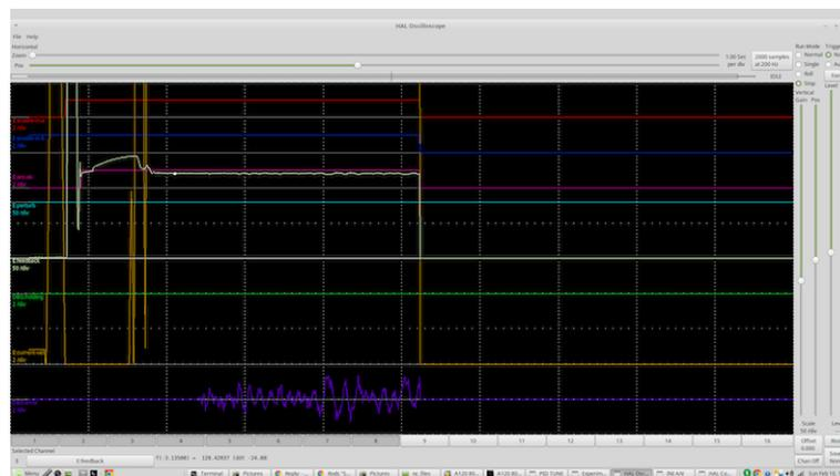
Es ist wichtig, dass die Plasmasteuerung "abwartet", bevor sie die Brennerspannung automatisch abtastet und mit der THC-Regelung beginnt. Wenn sie zu früh aktiviert wird, liegt die Spannung über der gewünschten Abschaltspannung und der Brenner wird heruntergefahren, um einen vermeintlichen Überhöhungszustand zu beheben.
