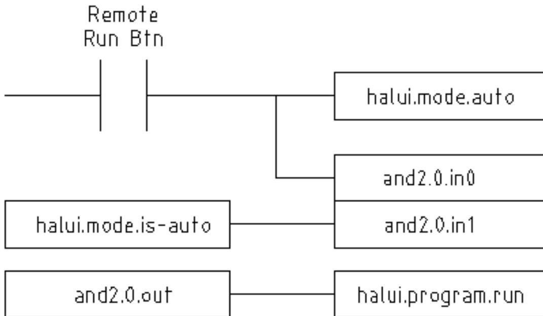
Abbildung 5.2: Remote-Start-Beispiel (Schema)
