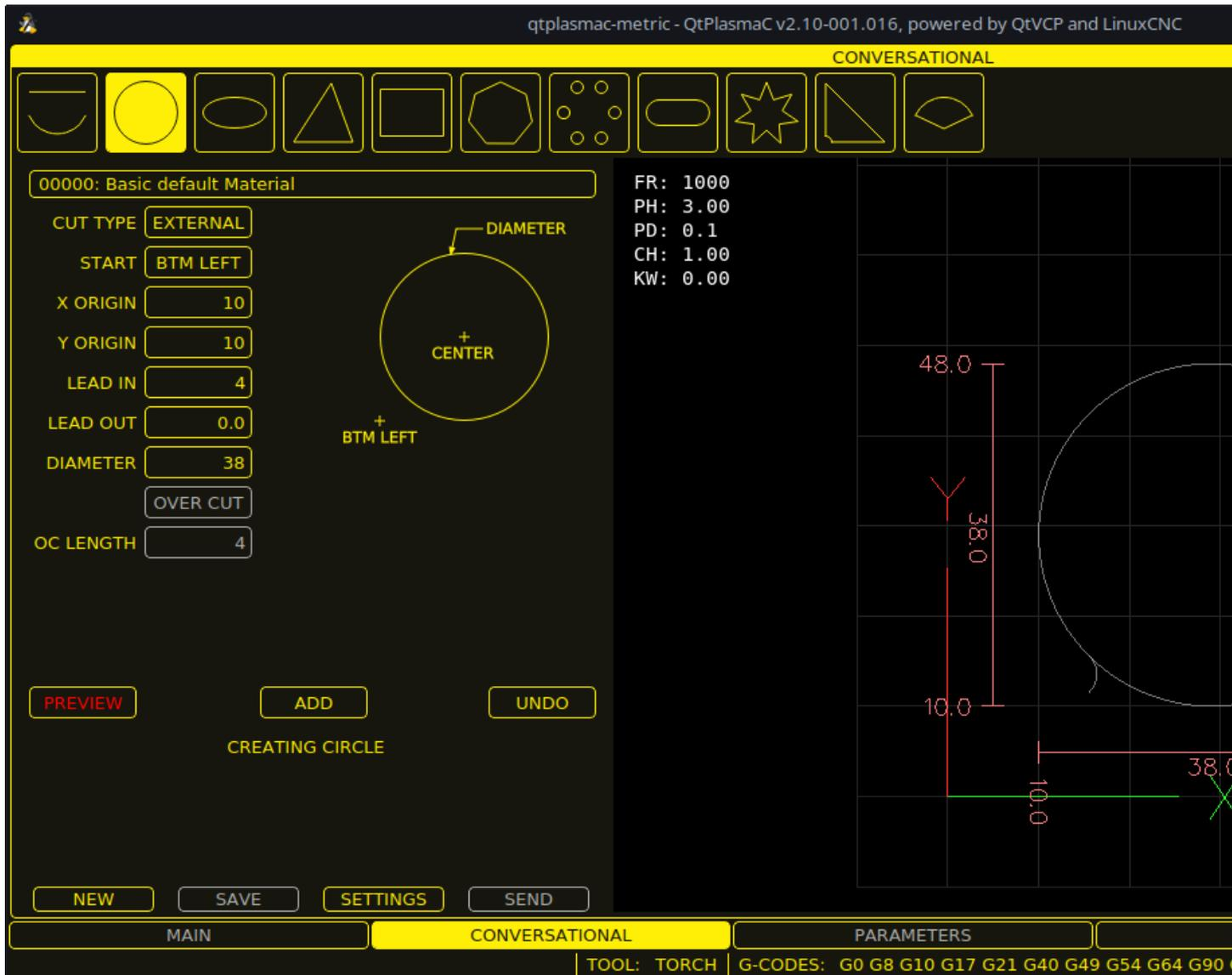
Die Registerkarte **CONVERSATIONAL** ermöglicht es dem Benutzer, verschiedene einfache Formen zum schnellen Schneiden zu programmieren, ohne dass eine CAM-Software erforderlich ist.
