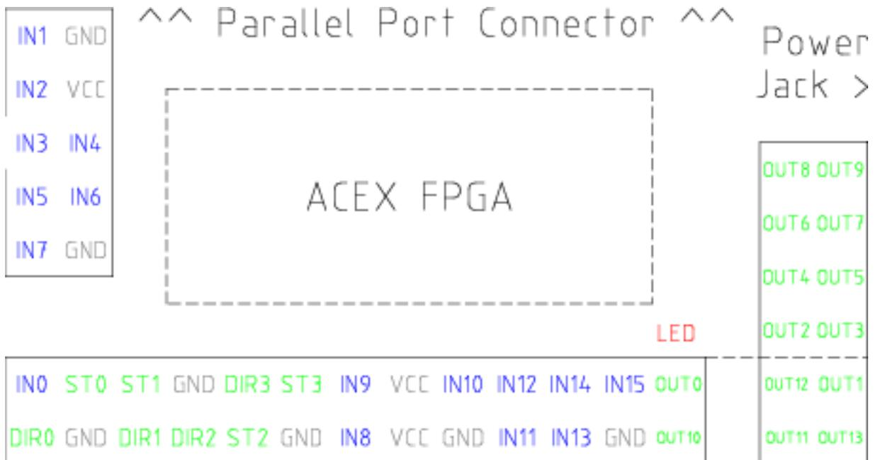
Abbildung 6.11: Pluto-Step Pinout
