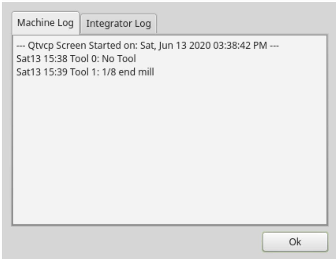
Abbildung 12.107: QtVCP MachineLogDialog: Dialog-Widget für Maschinen- und Debugging-Protokolle
