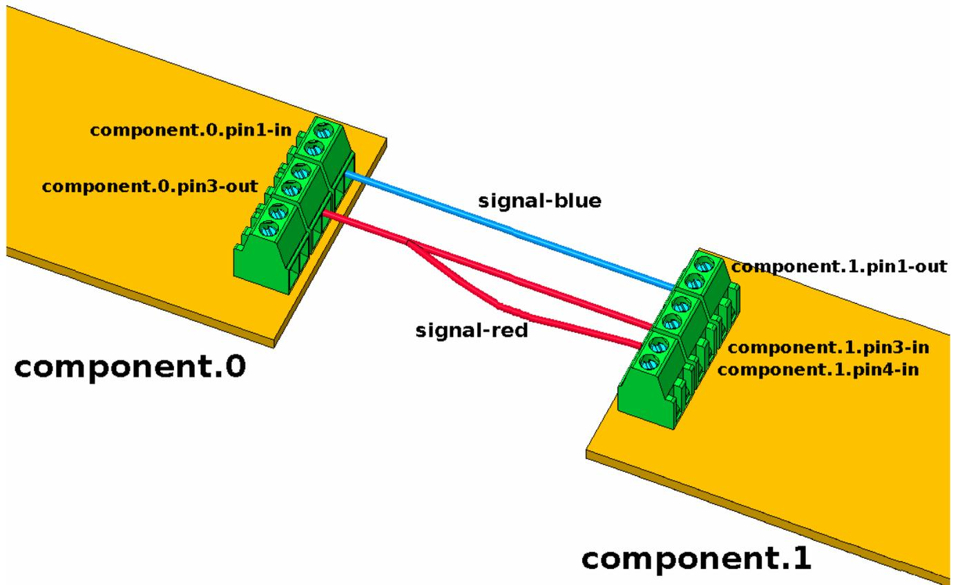
Abbildung 5.1: HAL-Konzept - Verbinden wie elektrische Schaltkreise.
