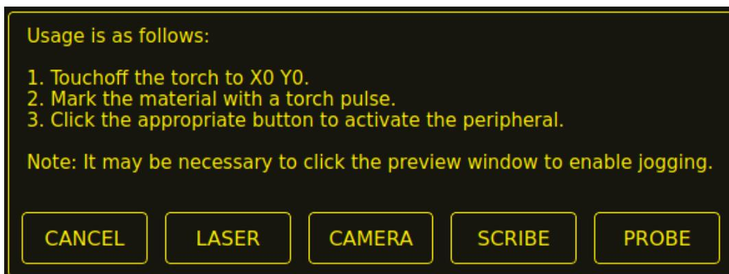
5. Klicken Sie auf die Schaltfläche X0Y0, um die Brennerposition auf Null zu setzen.
