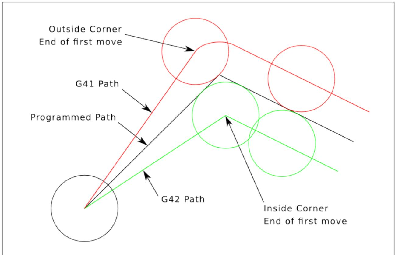
Abbildung 11.3: Ausgleich am Endpunkt (engl. Compensation End Point)
