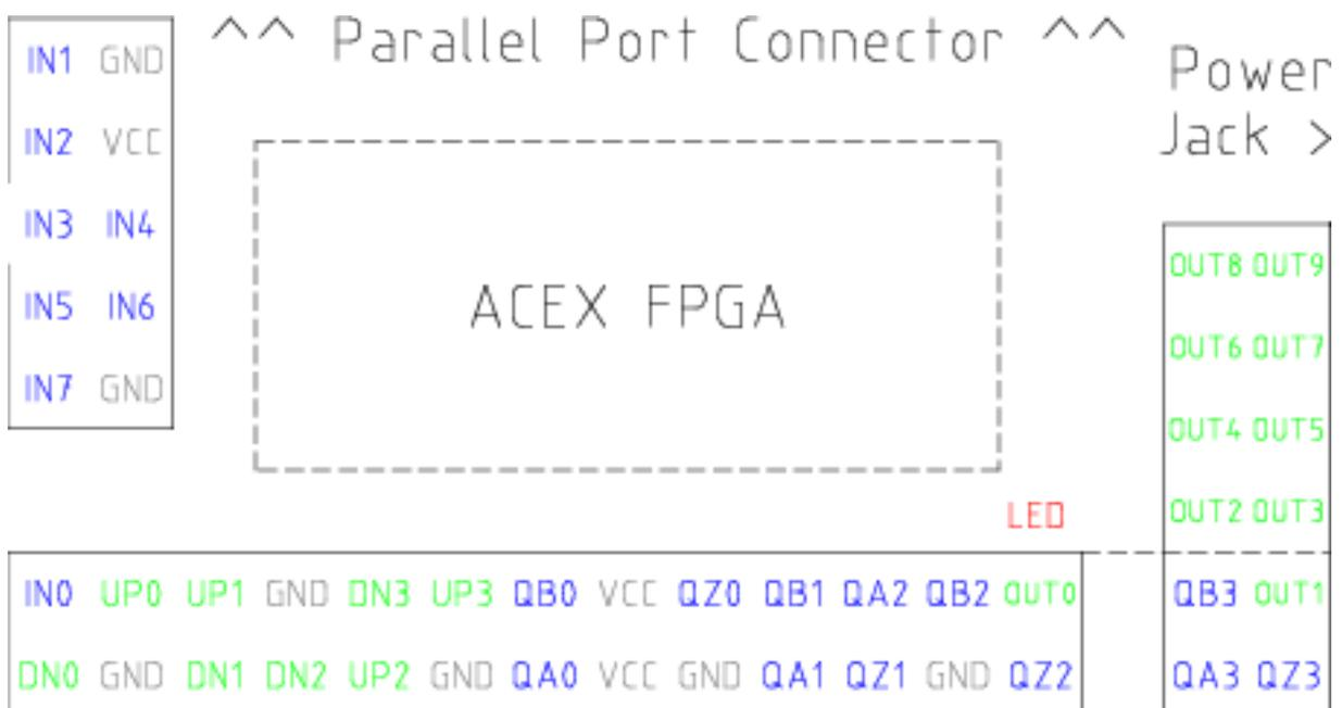
Abbildung 6.10: Pluto-Servo-Pinbelegung
