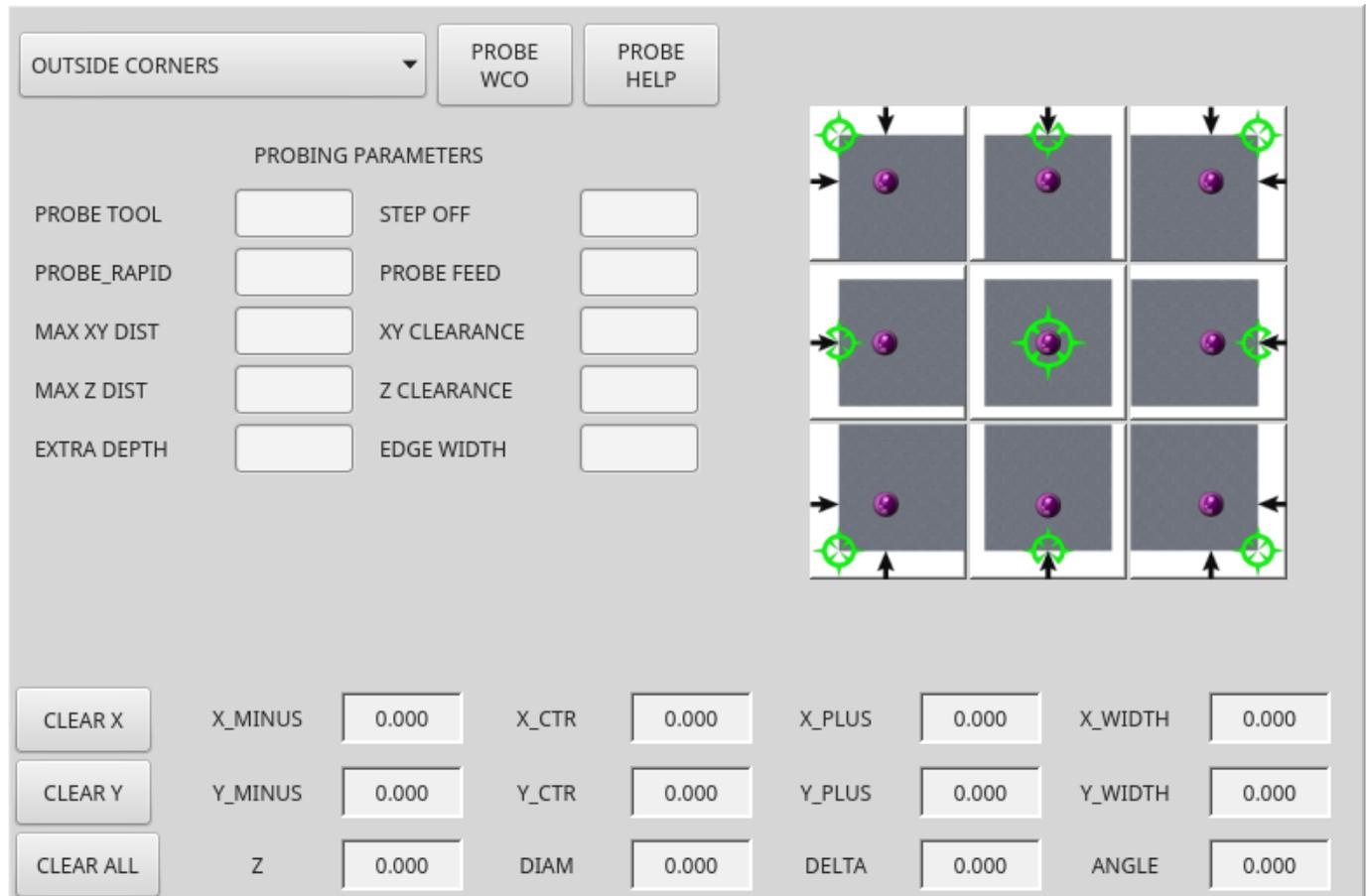
Abbildung 12.88: QtVCP *BasicProbe*: Einfaches Fräs-Tast-Widget
