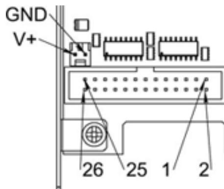
Abbildung 6.7: Pin-Nummerierung des Anschlusses für Referenzfahrt und Endschalter
