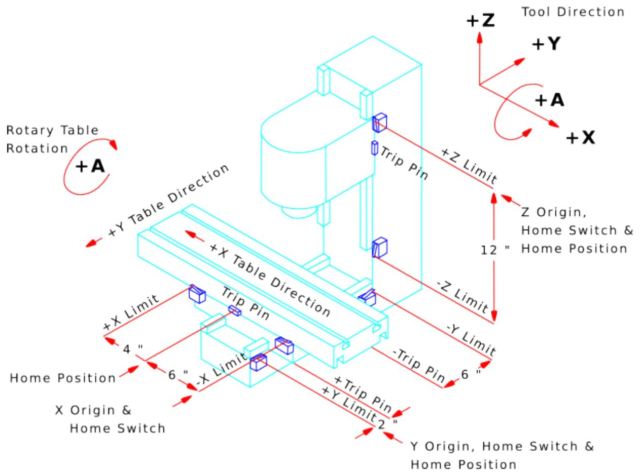
Abbildung 2.14: Typische Fräsen-Konfiguration
