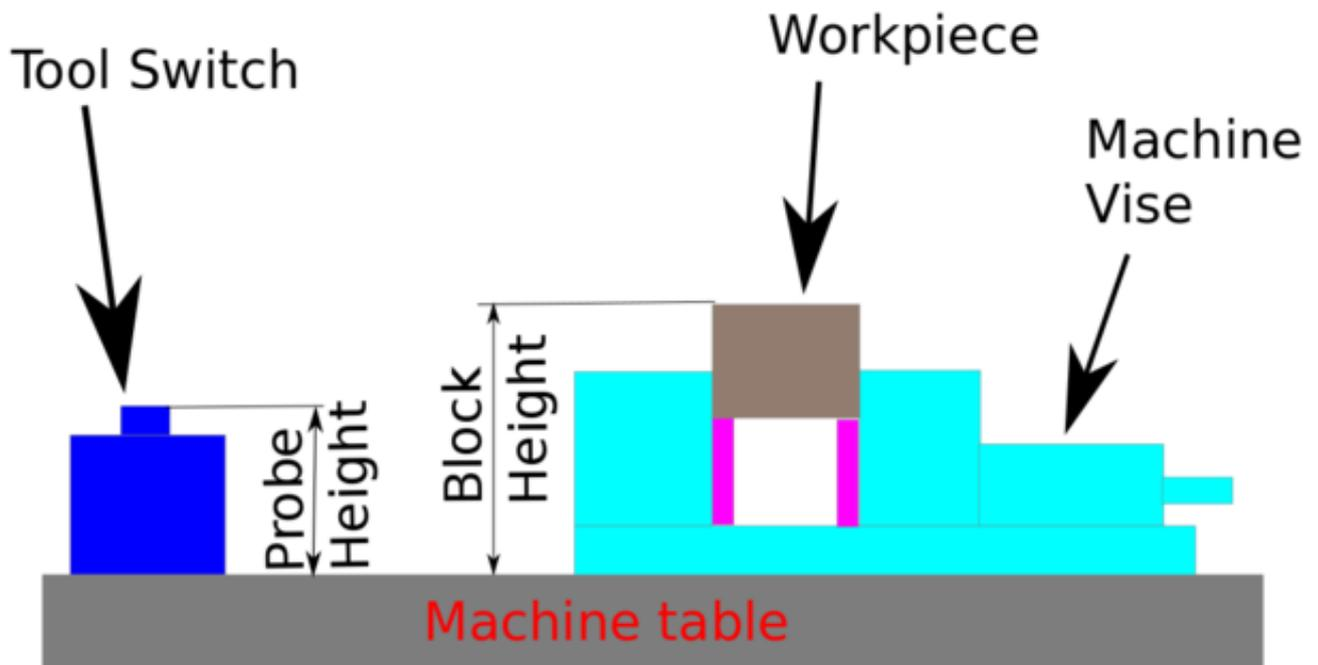
Abbildung 10.17: Werkzeugmessung Daten
