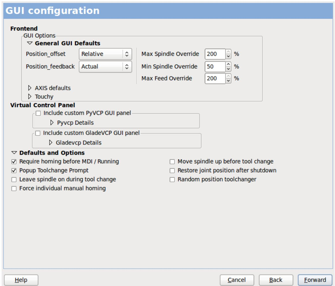
Abbildung 3.16: GUI-Konfiguration
