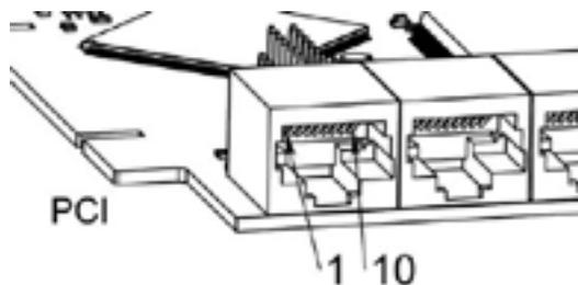
Abbildung 6.4: Pin-Nummerierung der Achsenverbinder
