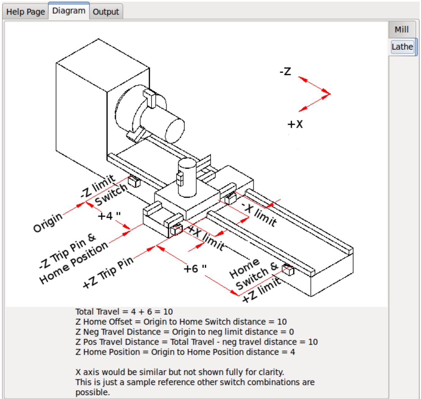
Abbildung 3.24: AXIS-Hilfsdiagramm
