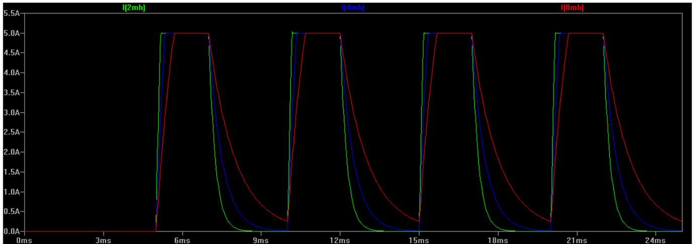
Eine höhere Antriebsspannung muss jedoch sorgfältig gehandhabt werden, da eine höhere Spannung den Stromfluss in jeder Spule erhöht, was zu einem entsprechenden Temperaturanstieg der Wicklung führt. Ein übermäßiger Temperaturanstieg in der Wicklung führt schließlich zu einer Überhitzung und zum Ausfall des Motors.
