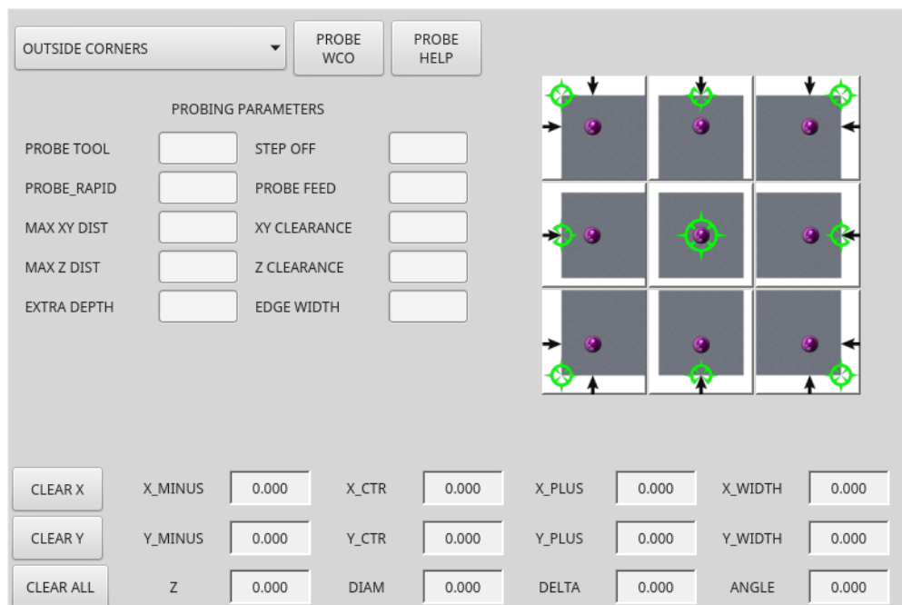
Figure 310. QtVCP BasicProbe: Einfaches Fräs-Tast-Widget
