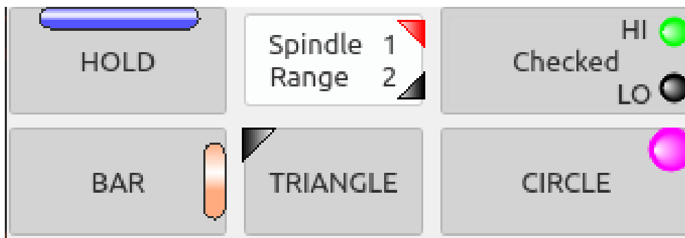
Figure 331. QtVCP PushButton : IndicatedPushButton-Schaltfläche, LED-Anzeige-Option
