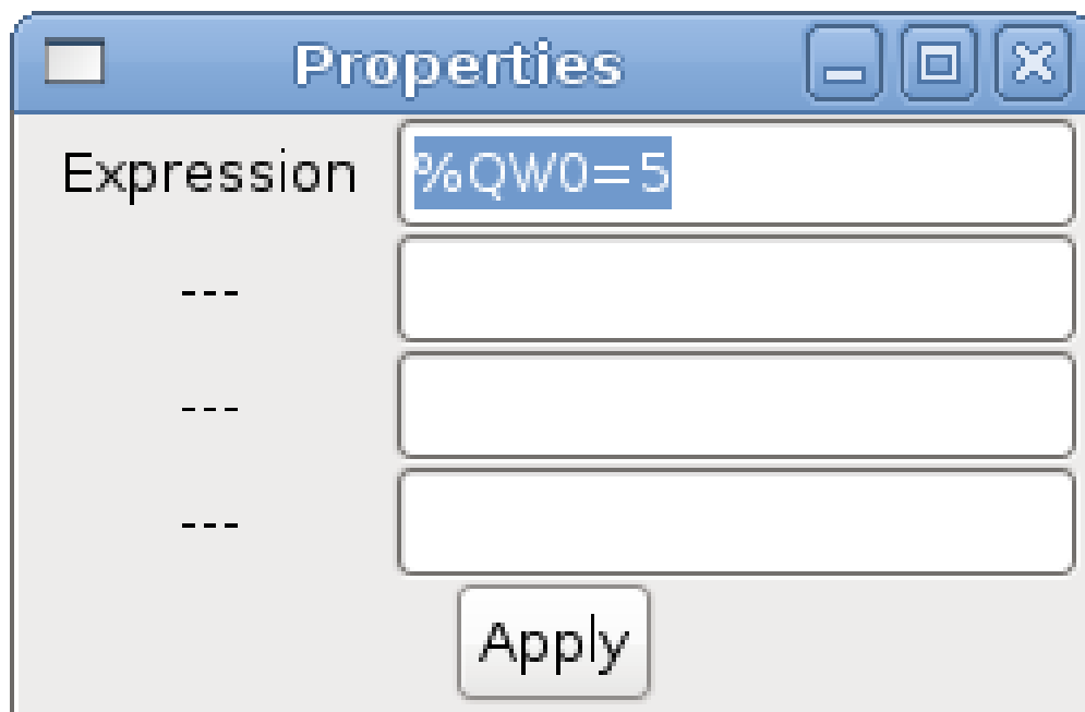
Figure 121. Beispiel für einen Zuweisungsausdruck
