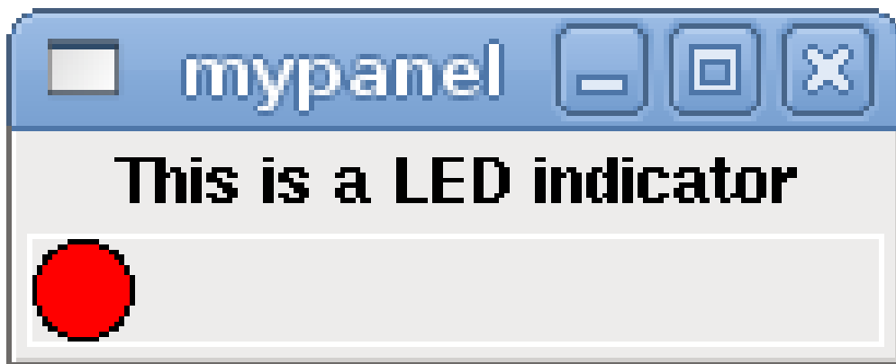
Figure 224. Einfaches PyVCP LED-Panel Beispiel
