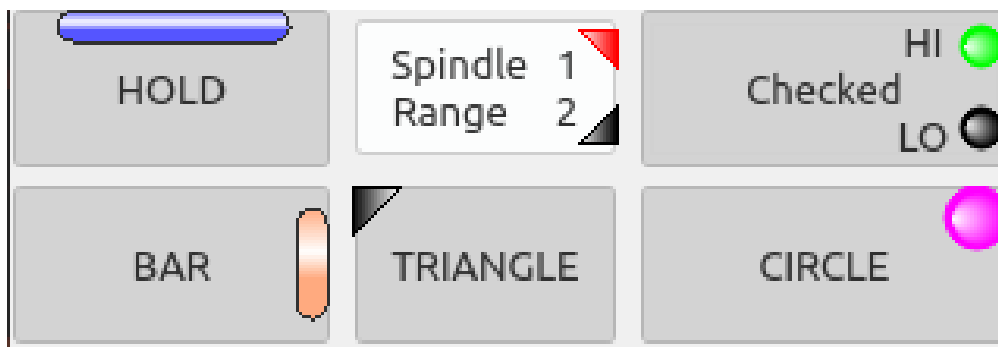
Figure 331. QtVCP PushButton: IndicatedPushButton-Schaltfläche, LED-Anzeige-Option
