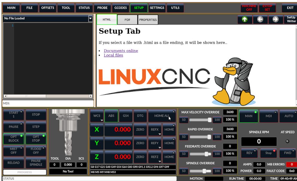
Figure 186. QtDragon - Beispiel für die Registerkarte Setup
