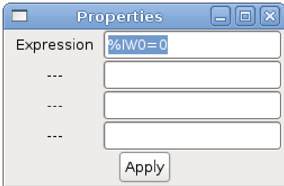
Figure 122. Beispiel für einen Vergleichsausdruck
