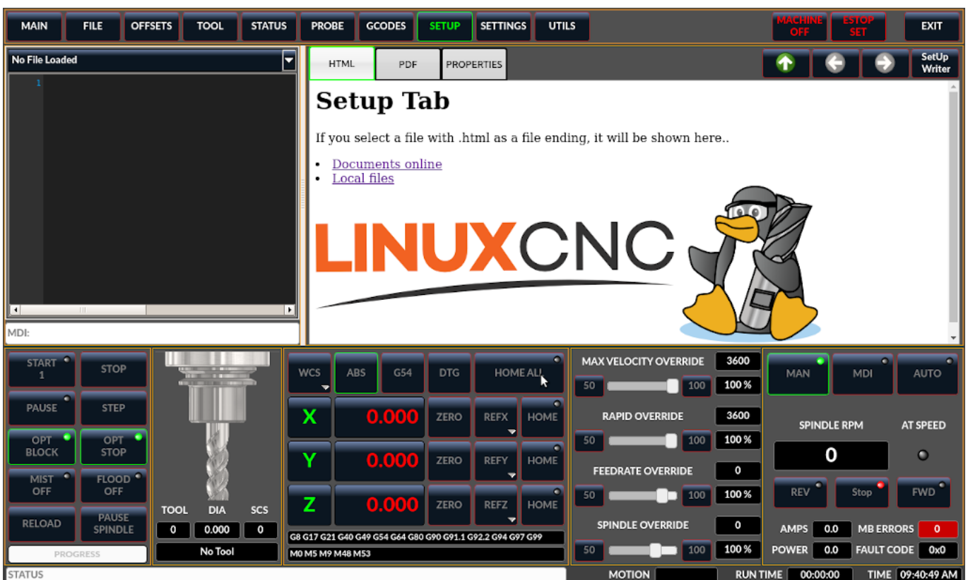
Abbildung 10.35: QtDragon - Beispiel für die Registerkarte Setup
