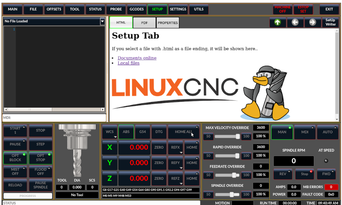
Abbildung 10.35: QtDragon - Beispiel für die Registerkarte Setup
