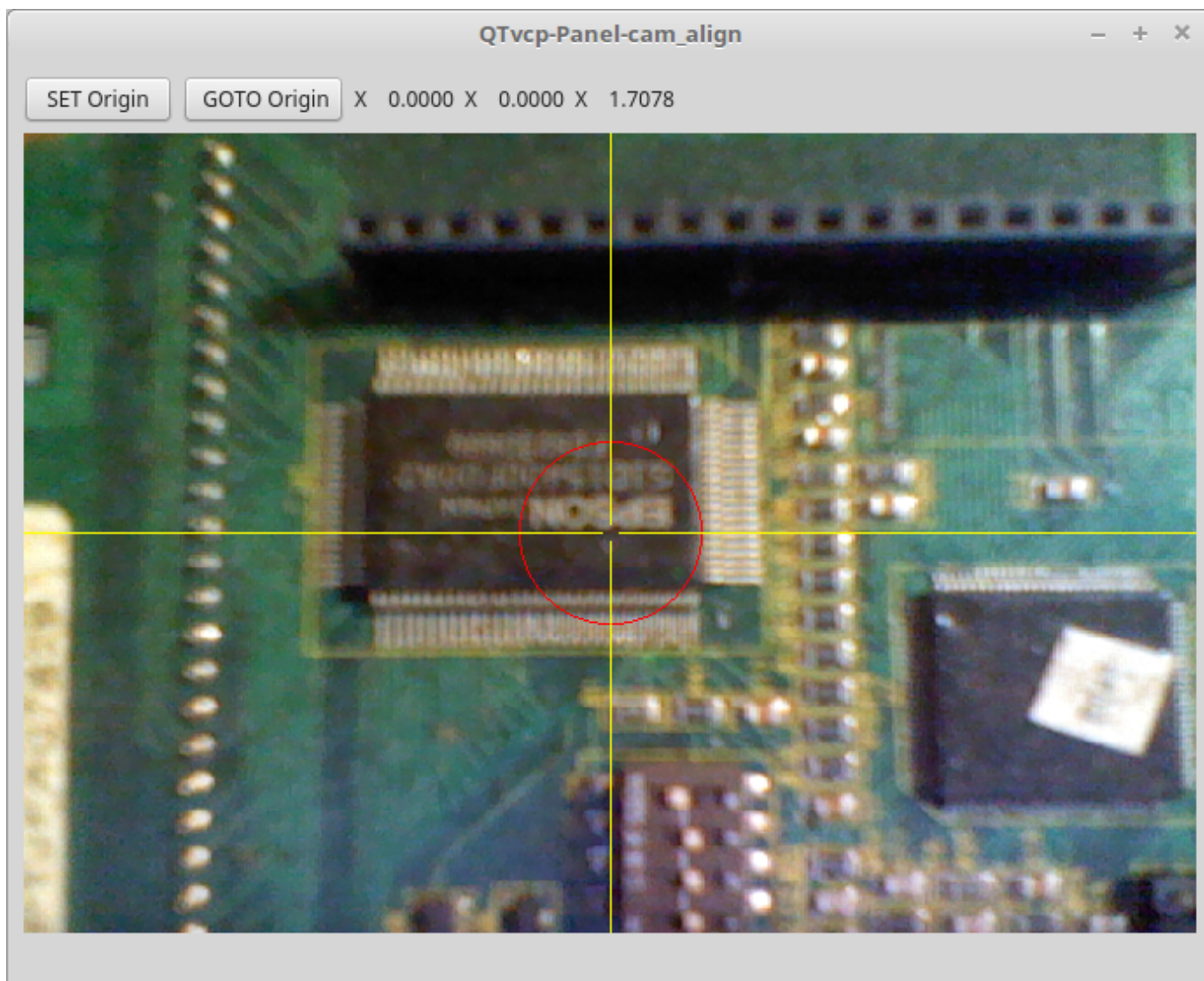
Abbildung 12.74: QtVCP cam_align Panel zur Kamera-basierten Ausrichtung
